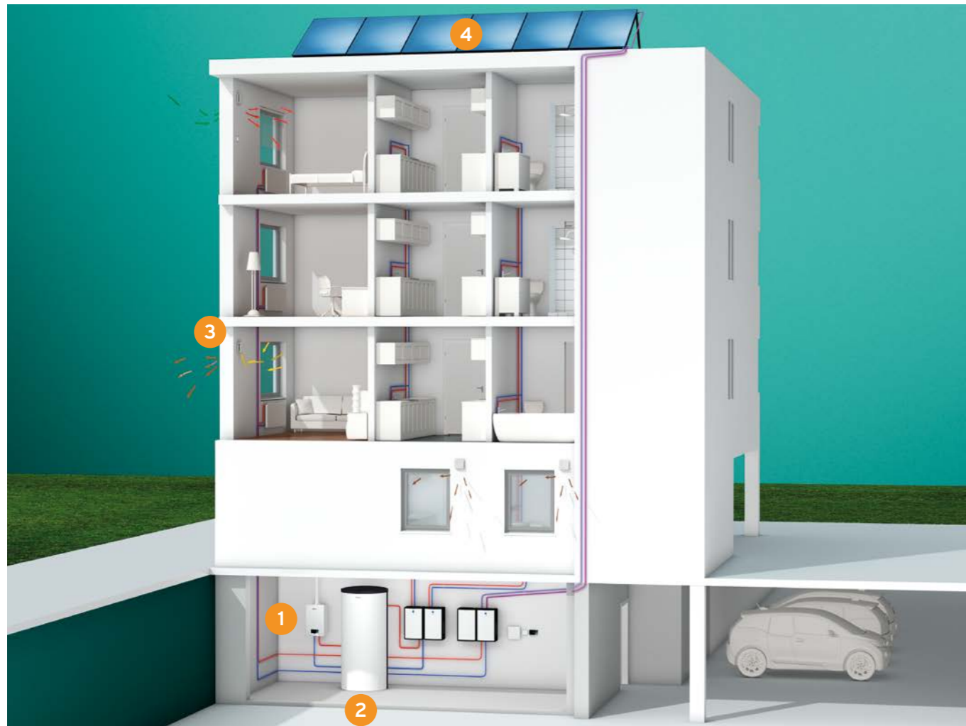
ecoTEC plus VC als Zentralheizung im Keller
