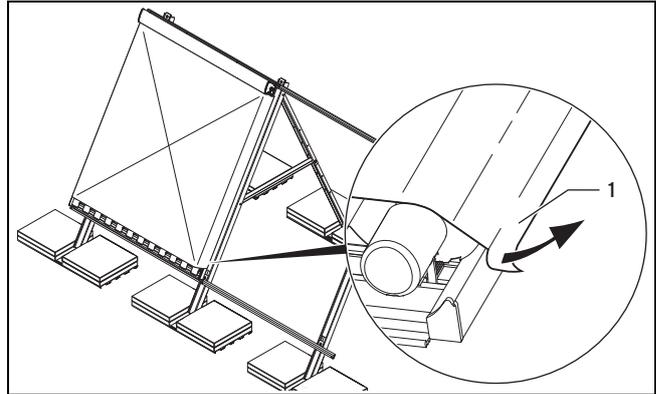
19. Damit Sie die Sonnenschutzfolie nach der Inbetriebnahme leichter abziehen können, lösen Sie die Sonnenschutzfolie an den Rändern des Kollektors **(1)**.
