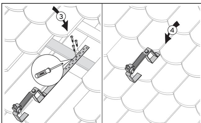
4. Schrauben Sie den Dachanker mit den drei mitgelieferten Schrauben am Dachsparren bzw. an der Dachlatte fest **(3)**.
