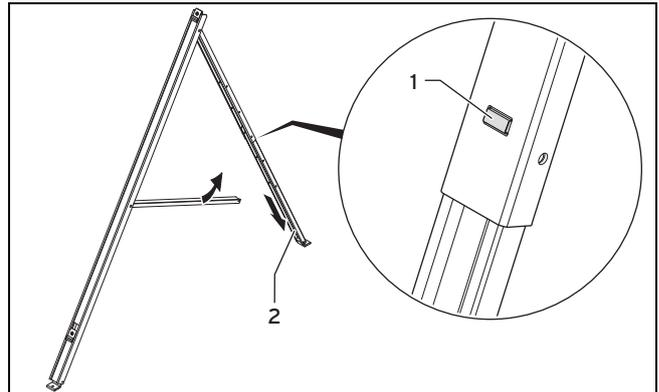
4. Drücken Sie den Arretierungsknopf (1) an der Teleskopschiene.
