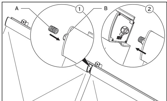
21. Verschrauben Sie den Doppelnippel **(A)** (aus Anschluss-Set **VTK** Erweiterungsset Art.-Nr. 0020076779) im Gewinde des zweiten Kollektors **(B)** mit der Überwurfmutter des ersten Kollektors **(1)** und **(2)**.
