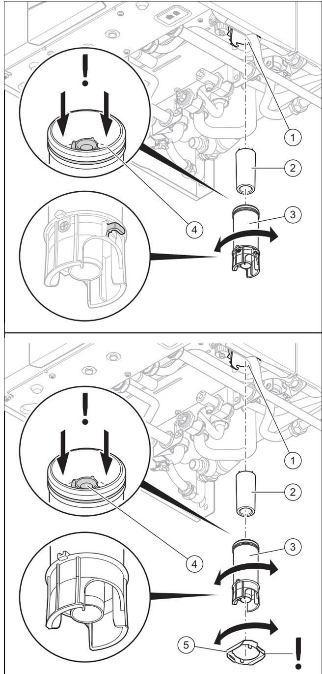
1. Lösen Sie ggf. den Sicherungsring (5).
