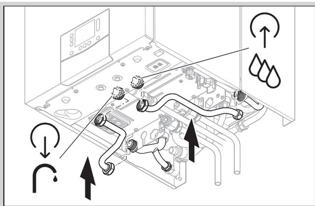
1. Installieren Sie die Rohre für Kalt-/Warmwasser normgerecht.
