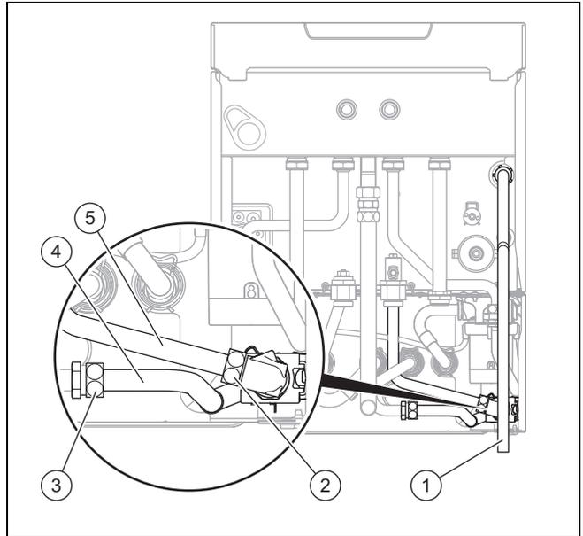
2. Nehmen Sie das Ablaufrohr (1) vom Sicherheitsventil des Wärmeerzeugers ab.
