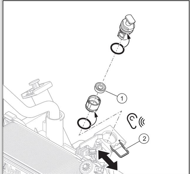
4. Ziehen Sie die Klammer (2) heraus in die Wartungsposition. Die Klammer ist gegen Herausfallen gesichert.
