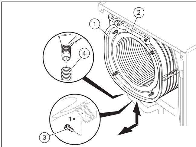
6. Ziehen Sie den Kondensatablaufschauch (4) vom Wärmetauscher (1) ab.
