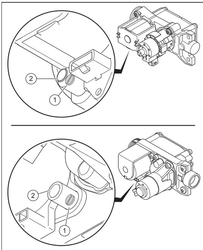
3. Lösen Sie die Prüfschraube (1).
