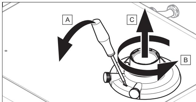
1. Stecken Sie einen Schraubendreher in den Schlitz zwischen den Messstutzen.
