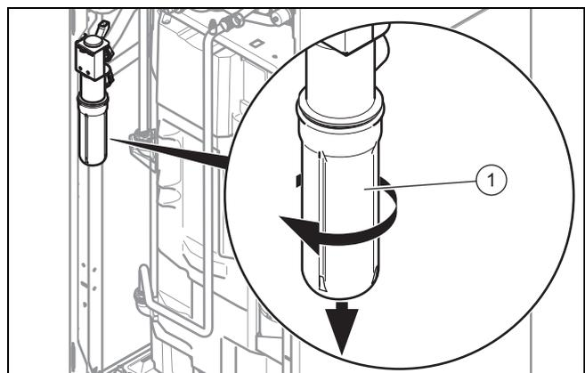
1. Entfernen Sie das Unterteil des Siphons (1), indem Sie den Bajonettverschluss gegen den Uhrzeigersinn drehen.
