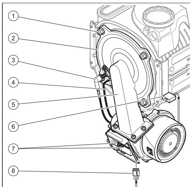
8. Ziehen Sie den Stecker des Zündkabels (3) und des Erdungskabels (4) von der Zündelektrode ab.
