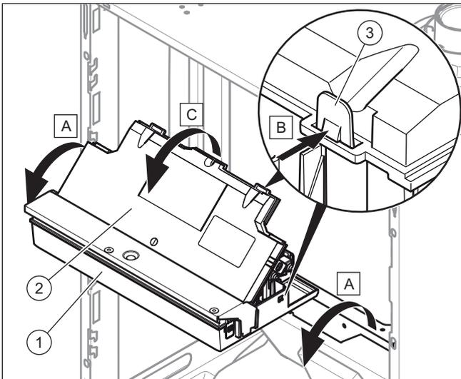
2. Klappen Sie den Schaltkasten (1) nach vorn.
