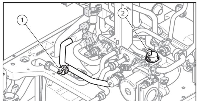
1. Schließen Sie die Wartungshähne im Heizungsanlauf und Heizungsrücklauf.
