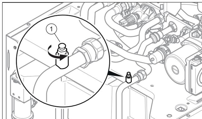
3. Öffnen Sie den Luftabscheider (1) und verbinden Sie ihn über einen Schlauch mit dem Ablass oder einem Behälter.
