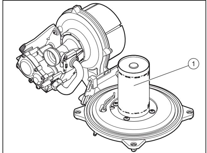
2. Lösen Sie die vier Schrauben des Brenners (**1**).
