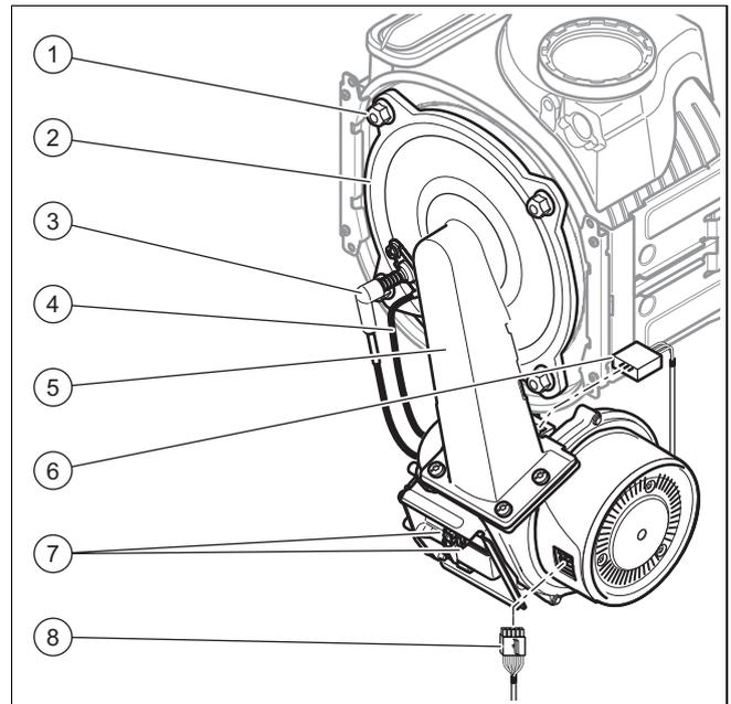
1. Bringen Sie das Thermo-Kompaktmodul (5) am Wärmetauscher an.
