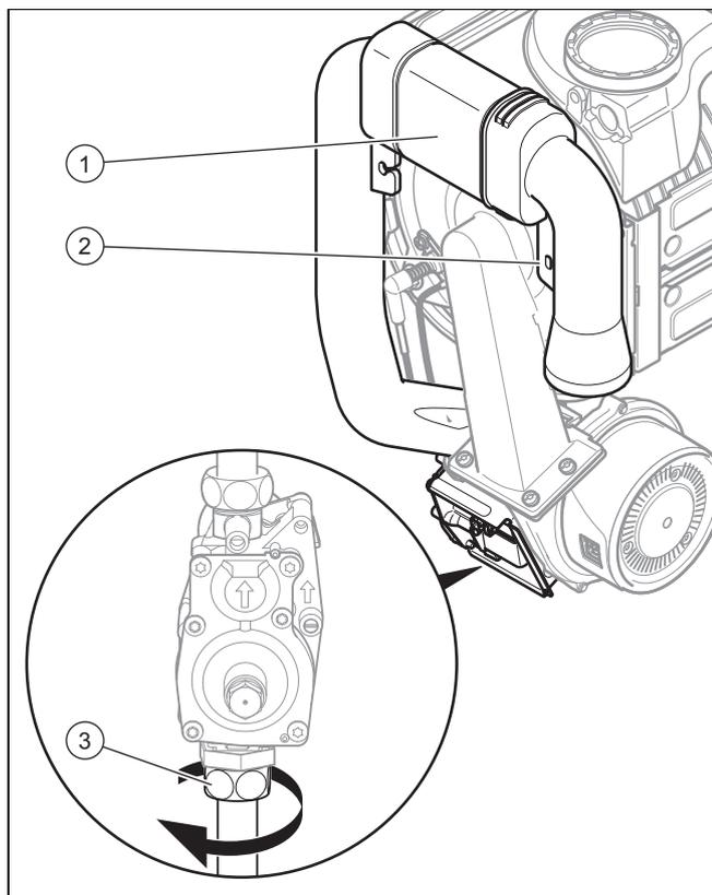
6. Lösen Sie die Befestigungsschraube (2) und ziehen Sie das Luftansaugrohr (1) vom Ansaugstutzen ab.
