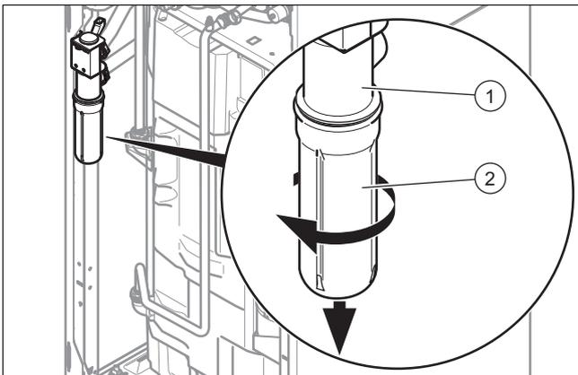
1. Entfernen Sie das Unterteil (2) des Siphons (1), indem Sie den Bajonettverschluss gegen den Uhrzeigersinn drehen.
