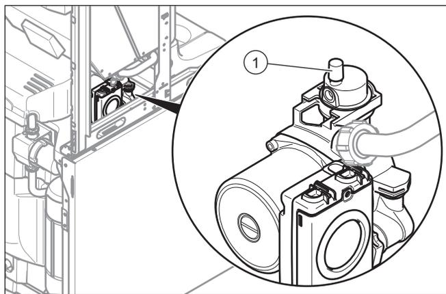
1. Lockern Sie die Kappe des Schnellentlüfters (1) um ein bis zwei Umdrehungen und belassen Sie sie in dieser Stellung, da sich das Gerät auf diese Weise während des Betriebs automatisch entlüftet.
