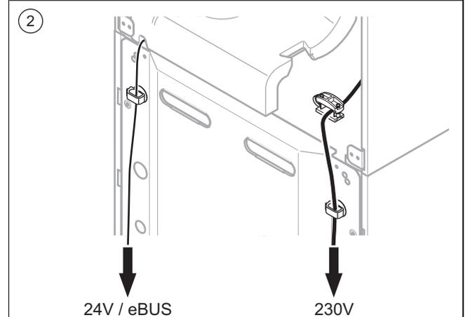
1. Verlauf der Kabel am Schaltkasten
