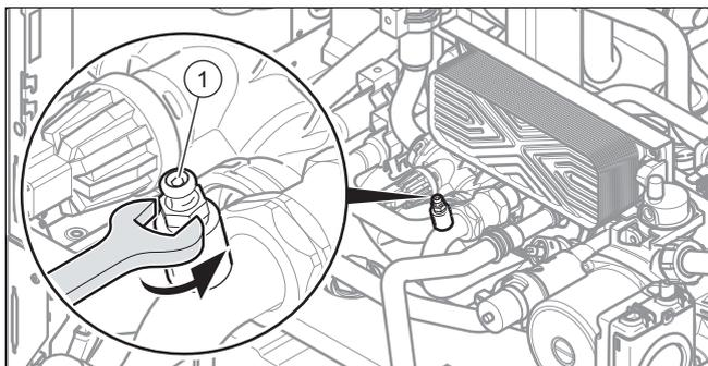
1. Öffnen Sie das Kaltwasser-Absperrventil am Produkt.
