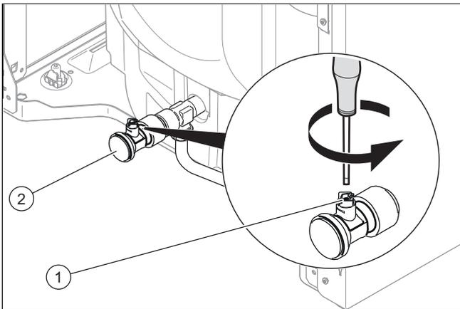
1. Schließen Sie die Trinkwasserhähne.
