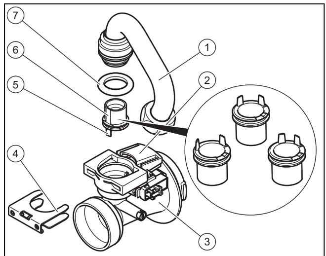
5. Bauen Sie das Gasverbindungsrohr (1) vom Venturi (3) ab, indem Sie die Klammer (4) abziehen und das Gasverbindungsrohr senkrecht herausziehen. Entsorgen Sie die Dichtung (7).
