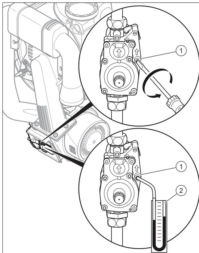
2. Lösen Sie mit einem Schraubendreher die Dichtschraube am Messanschluss (1) (Schraube unten) der Gasarmatur.
