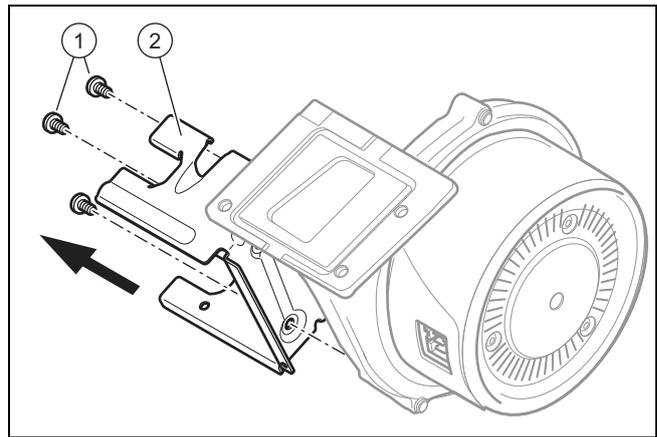
11. Demontieren Sie die Halterung (2) der Gasarmatur vom Gebläse. Lösen Sie hierzu die drei Schrauben (1).
