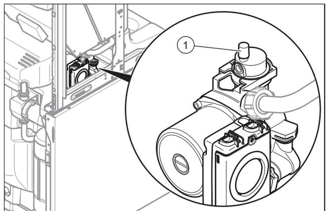
1. Lockern Sie die Kappe des Schnellentlüfters (1) um ein bis zwei Umdrehungen und belassen Sie sie in dieser Stellung, da sich das Gerät auf diese Weise während des Betriebs automatisch entlüftet.
