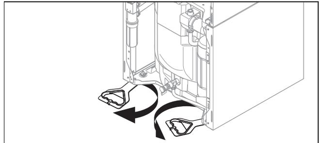
3. Schwenken Sie die unter dem Produkt befindlichen Tragegriffe nach vorn.
