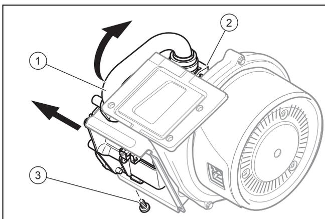
7. Entnehmen Sie die Baugruppe, bestehend aus Gebläse, Venturidüse und Gasarmatur, aus dem Gerät.
