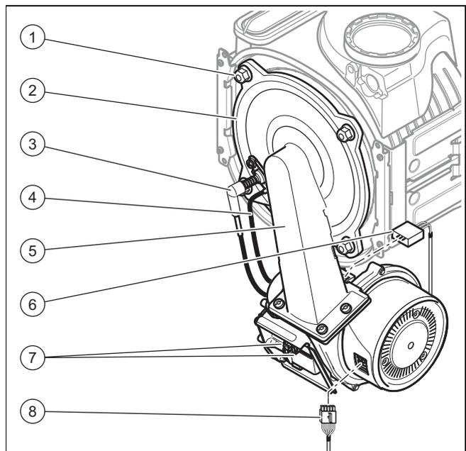
8. Ziehen Sie den Stecker des Zündkabels (3) und des Erdungskabels (4) von der Zündelektrode ab.
