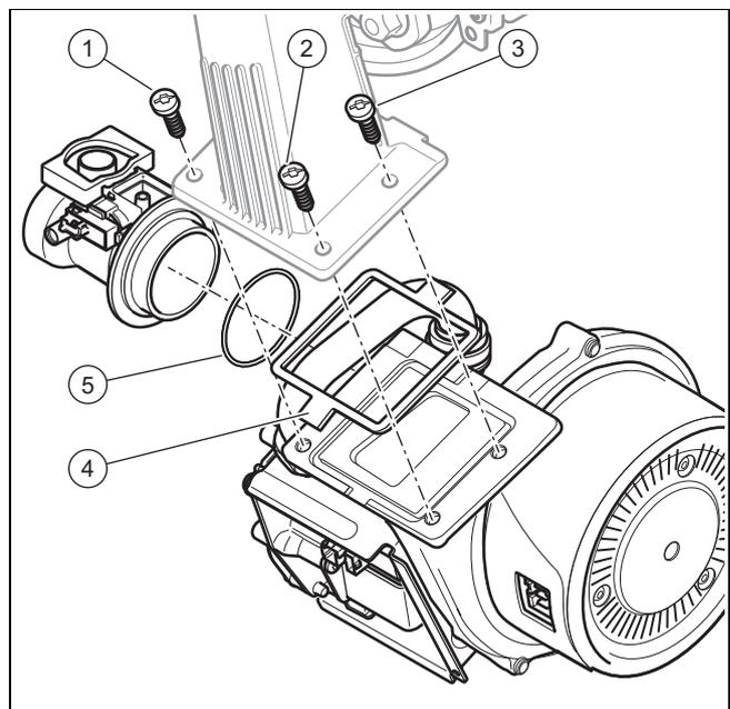
13. Bauen Sie die Bauteile in umgekehrter Reihenfolge wieder ein. Verwenden Sie an Stelle (4) und (5) unbedingt neue Dichtungen. Halten Sie sich an die Anzugsreihenfolge für die drei Schrauben, die das Gebläse mit dem Mischrohr verbinden, indem Sie der Nummerierung (1), (2) und (3) folgen.
