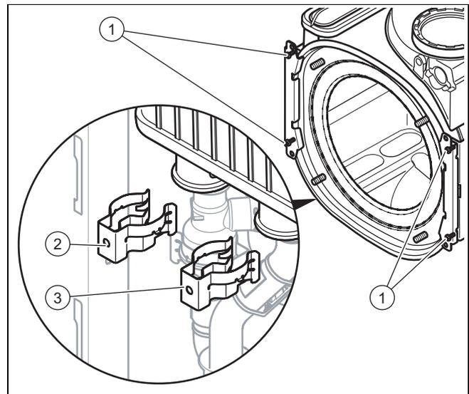
4. Ziehen Sie die Klammern (2) und (3) am Vorlaufanschluss und am Rücklaufanschluss ab.
