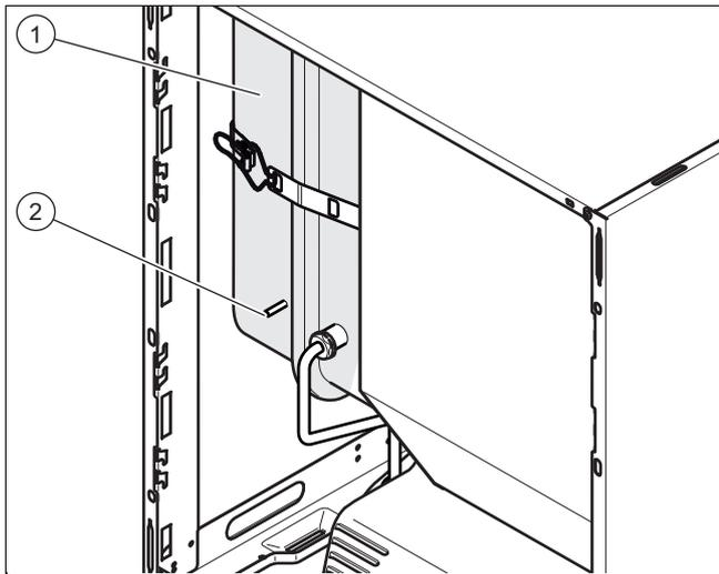
1. Schließen Sie die Wartungshähne und entleeren Sie das Produkt.
