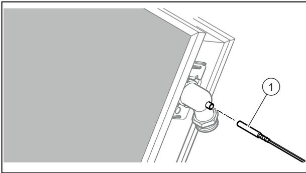
1. Beachten Sie die Installationsanleitung zum Solarkollektor, um den Solarfühler zu installieren.
