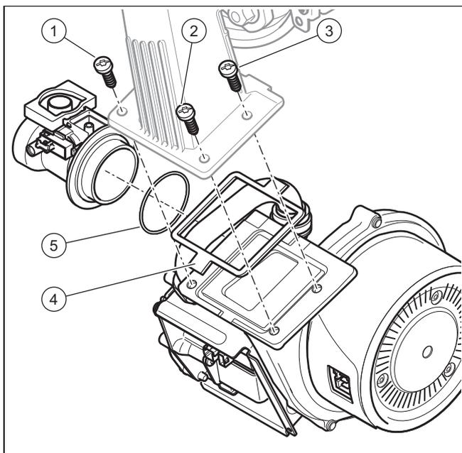
13. Bauen Sie die Bauteile in umgekehrter Reihenfolge wieder ein. Verwenden Sie an Stelle (4) und (5) unbedingt neue Dichtungen. Halten Sie sich an die Anzugsreihenfolge für die drei Schrauben, die das Gebläse mit dem Mischrohr verbinden, indem Sie der Nummerierung (1), (2) und (3) folgen.
