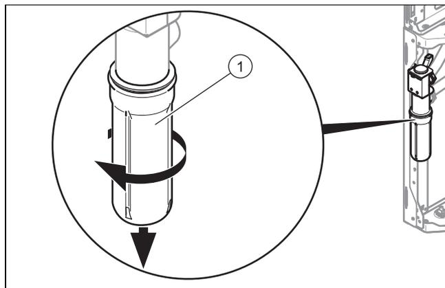
1. Entfernen Sie das Unterteil des Siphons (1), indem Sie den Bajonetverschluss gegen den Uhrzeigersinn drehen.
