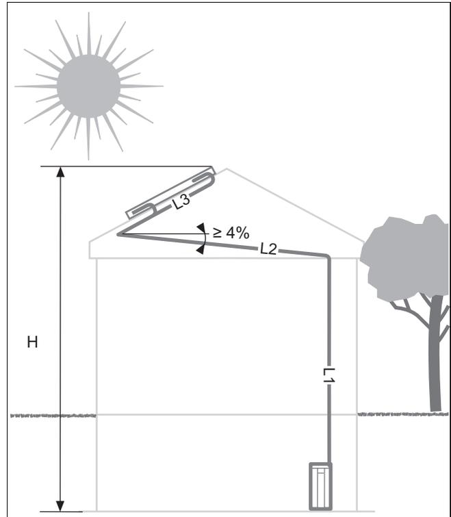
Die Gesamtlänge der Verrohrung zwischen den Solarkollektoren und dem Speicher darf die angegebenen Werte nicht überschreiten.
