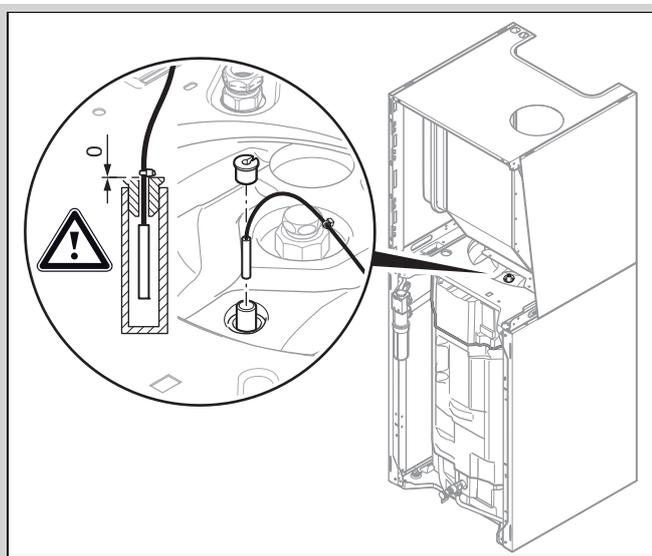
► Montieren Sie den Speichertemperaturfühler wie in der Abbildung gezeigt.
