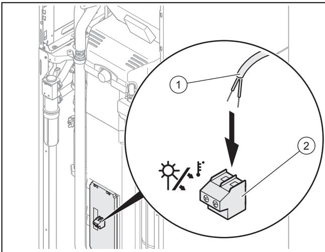
3. Schließen Sie das Kabel des Solarfühlers (1) am Solarstecker (2) an.
