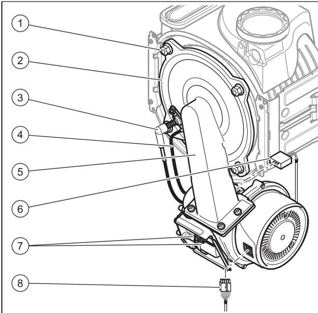
1. Bringen Sie das Thermo-Kompaktmodul (5) am Wärmetauscher an.
