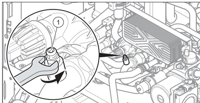
1. Öffnen Sie das Kaltwasser-Absperrventil am Produkt.
