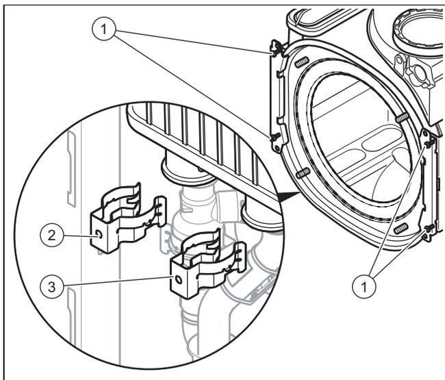
4. Ziehen Sie die Klammern (2) und (3) am Vorlaufanschluss und am Rücklaufanschluss ab.
