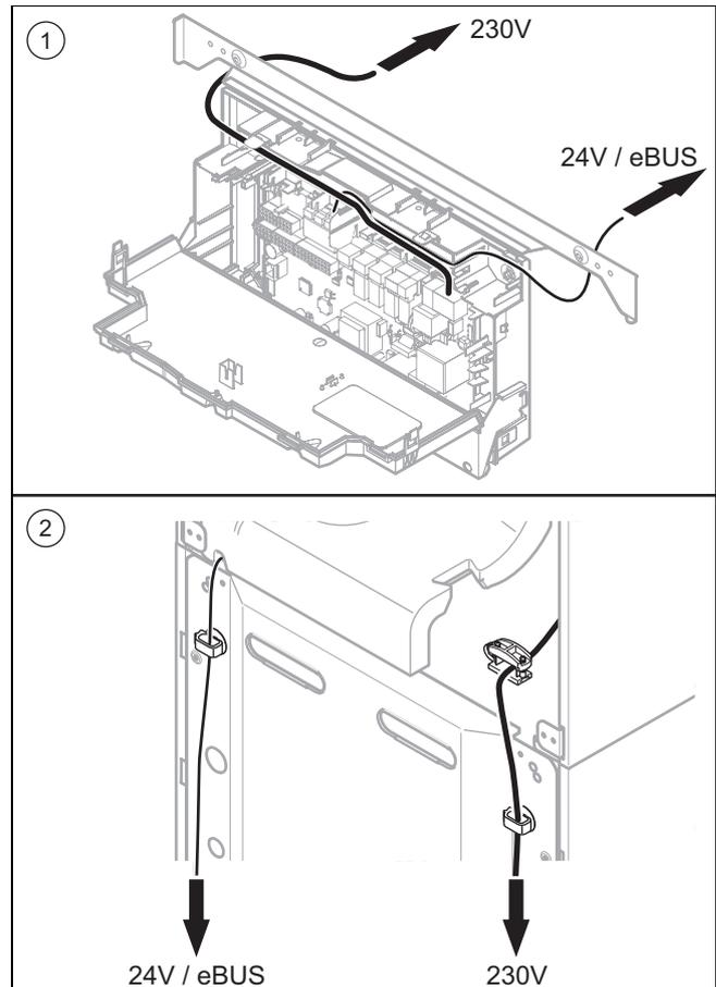
1. Verlauf der Kabel am Schaltkasten
