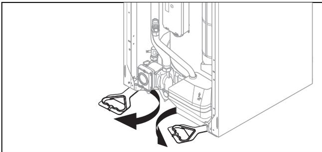
3. Schwenken Sie die unter dem Gerät befindlichen Tragegriffe nach vorn.
