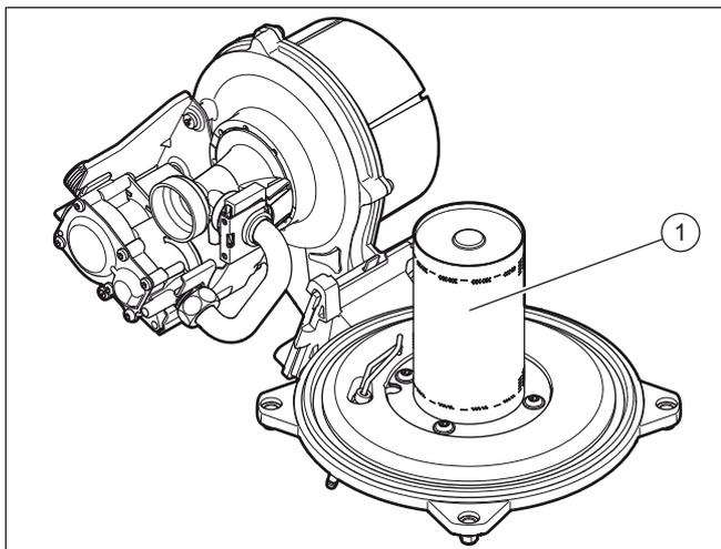
2. Lösen Sie die vier Schrauben des Brenners (1).
