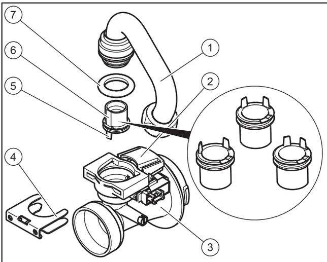
5. Bauen Sie das Gasverbindungsrohr (1) vom Venturi (3) ab, indem Sie die Klammer (4) abziehen und das Gasverbindungsrohr senkrecht herausziehen. Entsorgen Sie die Dichtung (7).
