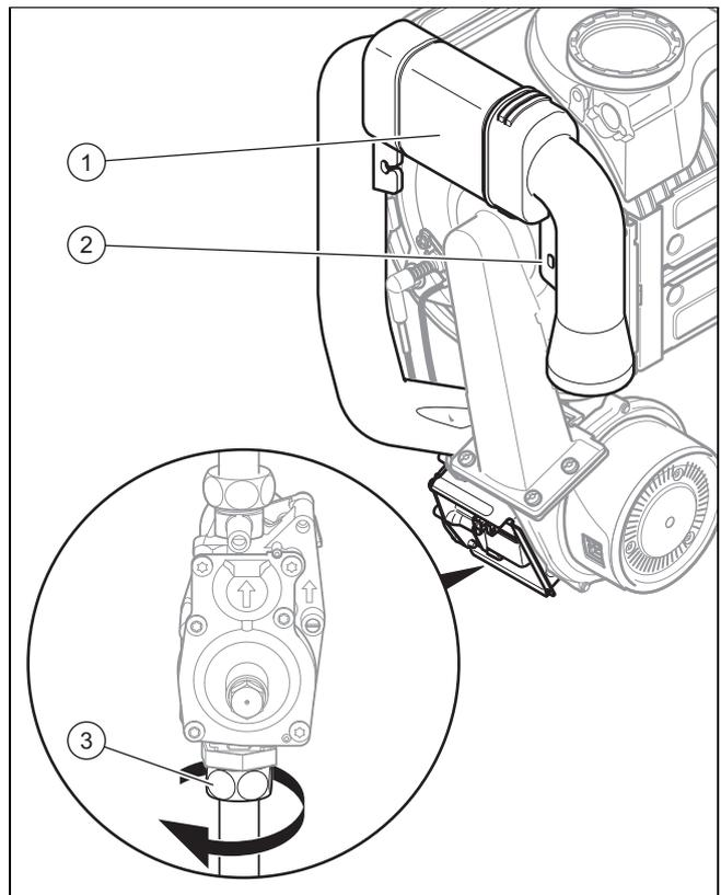
6. Lösen Sie die Befestigungsschraube **(2)** und ziehen Sie das Luftansaugrohr **(1)** vom Ansaugstutzen ab.
