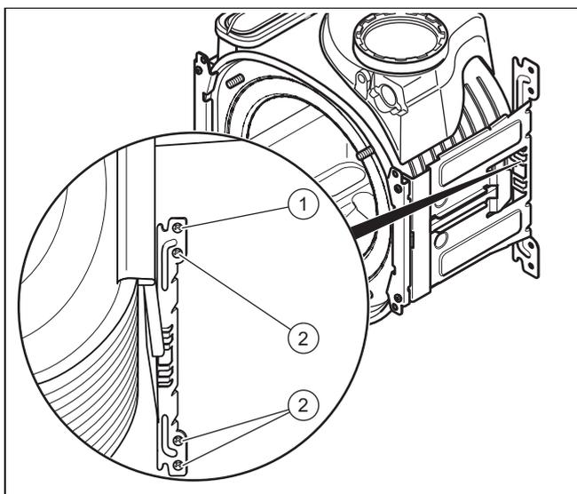
8. Trennen Sie die Steckverbindung (2) der thermischen Sicherung.
