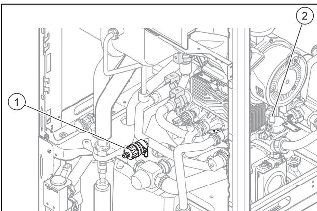
1. Schließen Sie die Wartungshähne im Heizungsvorlauf und Heizungsrücklauf.
