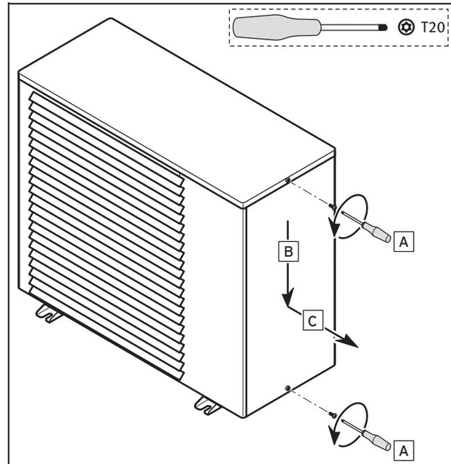
1. Entfernen Sie die beiden Schrauben (A).
