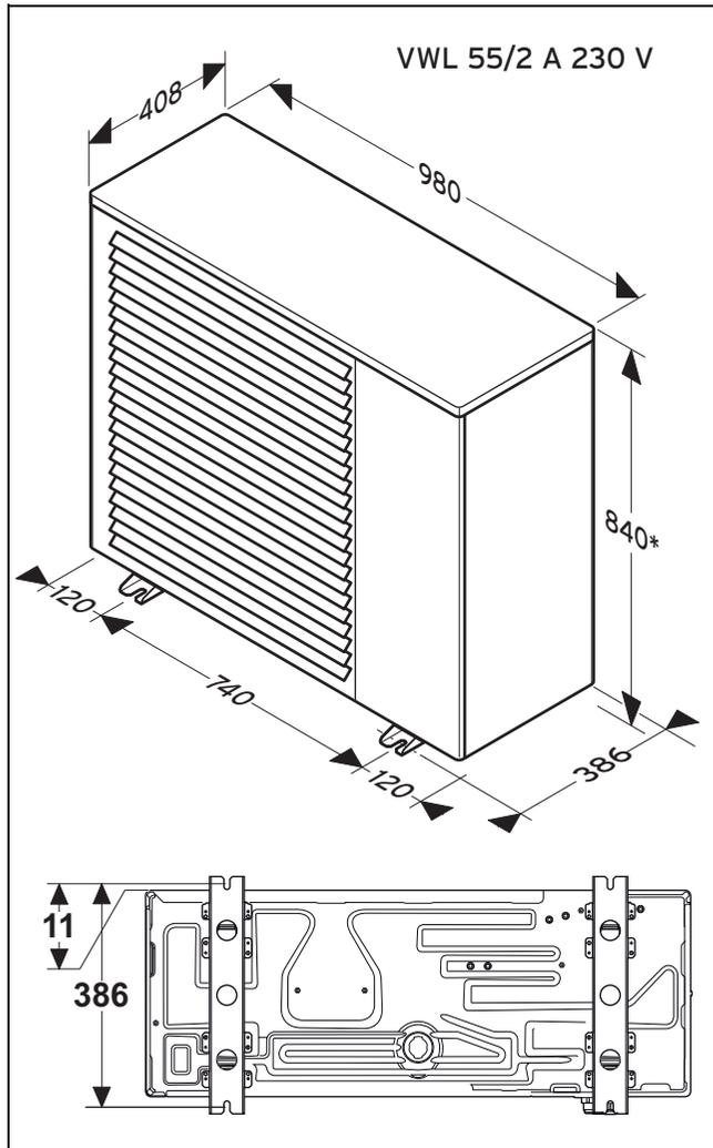
\* durch die Verwendung der mitgelieferten Schwingungsdämpfer erhöht sich das Maß um 45mm.
