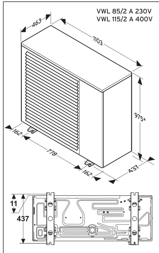
\* durch die Verwendung der mitgelieferten Schwingungsdämpfer erhöht sich das Maß um 45mm.
