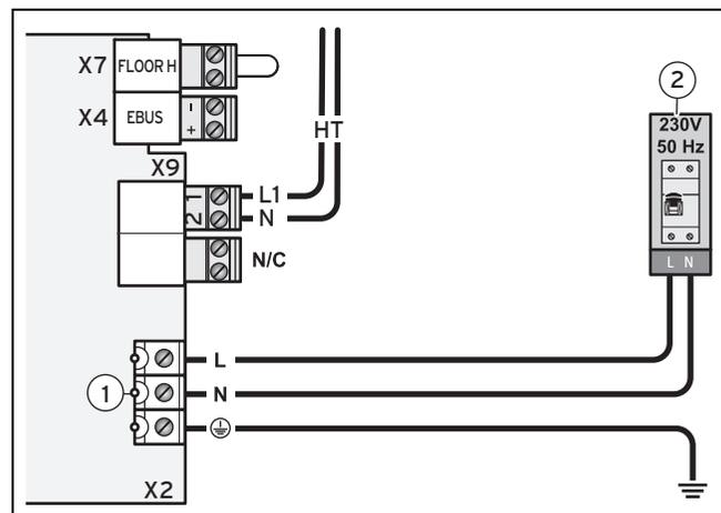
1 Netzanschlussklemmen im Produkt      2 Trennvorrichtung im Produkt
