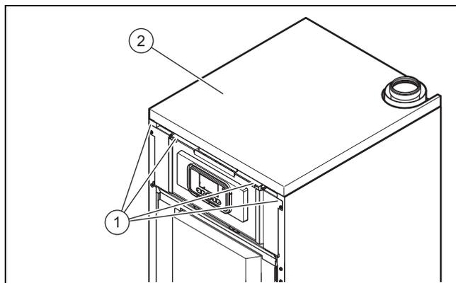
1. Lösen und entfernen Sie die Befestigungsschrauben (1) an den Blechen neben dem Schaltkasten.
