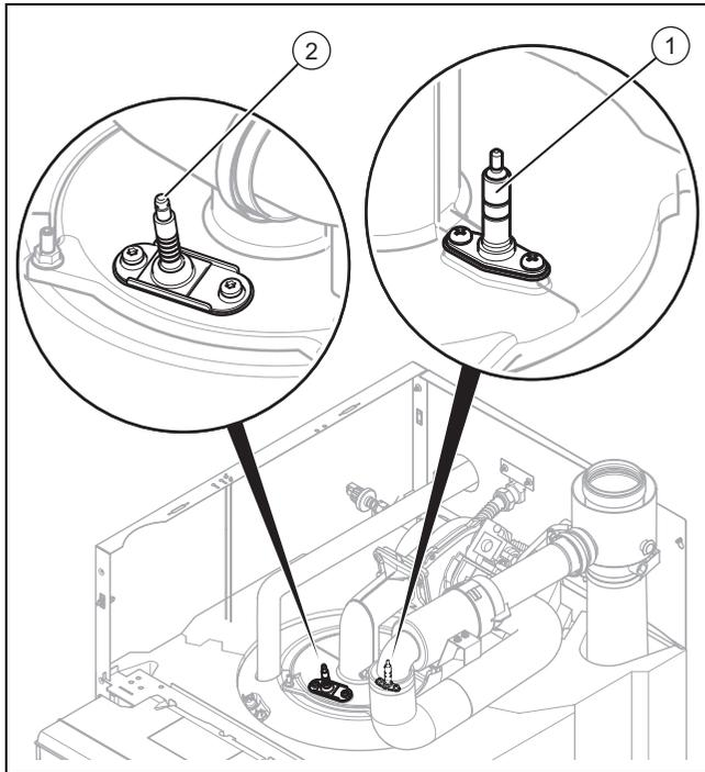
5. Ziehen Sie die Kabel von den Elektroden (1) und (2) ab.
