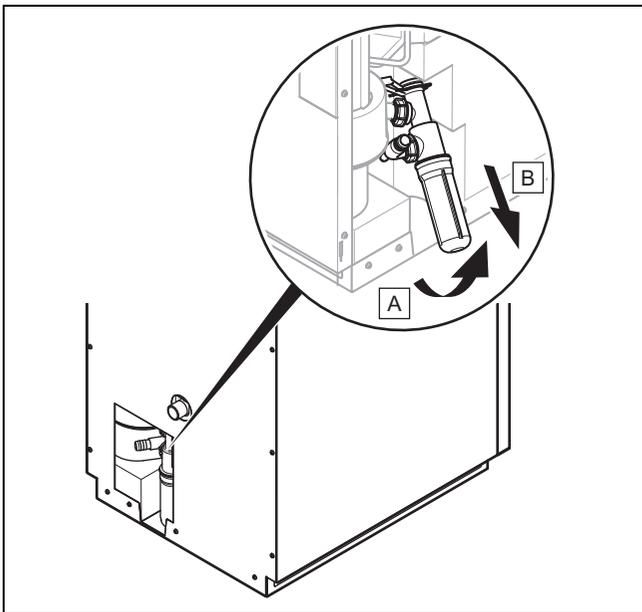
1. Drehen Sie den Kondensatsiphon nach hinten.
