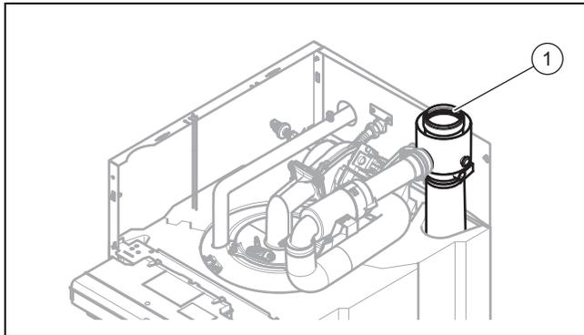
1. Schließen Sie vor dem Befüllen des Siphons die Kondensatablaufleitung an der Rückseite des Produkts an. Beachten Sie die Hinweise zur Verlegung der Kondensatablaufleitung im Kapitel "Kondensatablaufleitung anschließen" (→ Seite 11).
