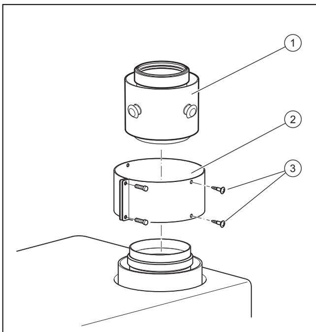
1. Stecken Sie das Zwischenstück (1) auf den Abgasanschluss des Produkts.
