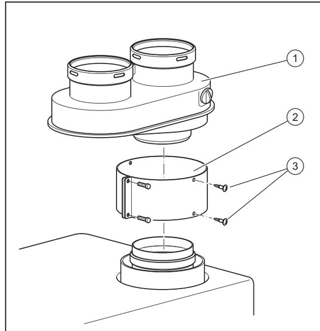
1. Stecken Sie das Anschlussstück (1) für den getrennten Anschluss auf das Produkt.
