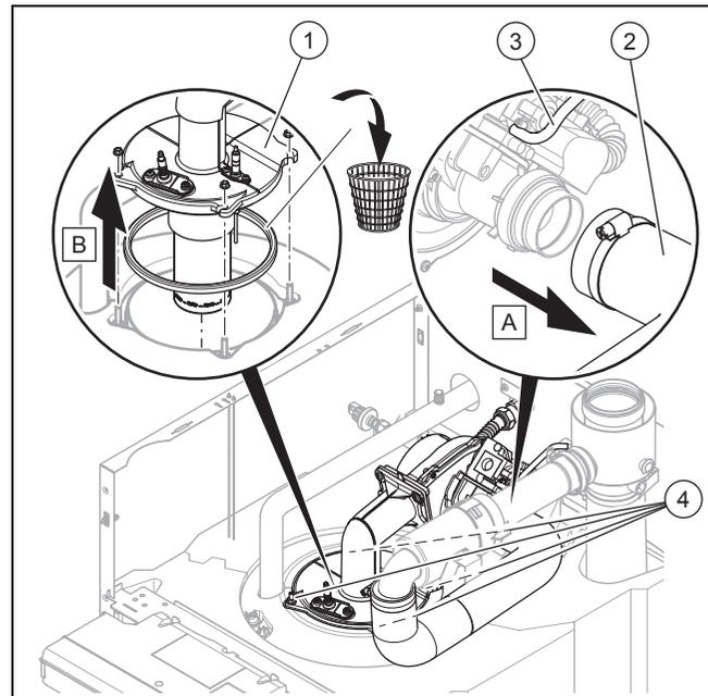
12. Ziehen Sie den Luftansaugschlauch **(2)** von dem Schalldämpfer ab.
