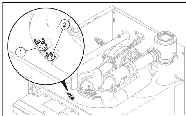
4. Ziehen Sie das Kabel vom Sicherheitstemperaturbegrenzer (1) oder Vorlauftemperaturfühler (2) ab.
