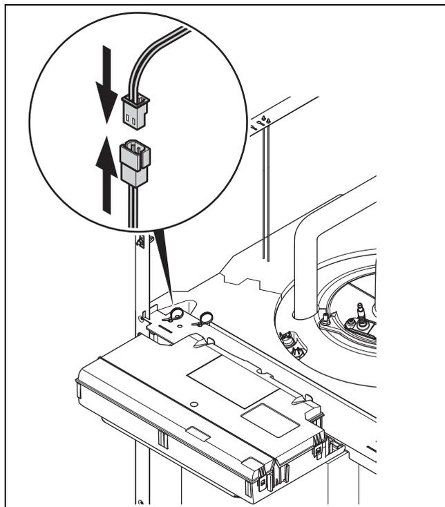
1. Schließen Sie den Speichertemperaturfühler am Kabelbaum an.
