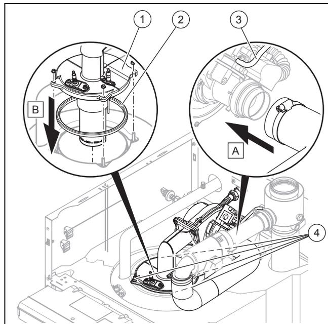
1. Erneuern Sie die Brennkammerdichtung (2) im Brennerflansch.
