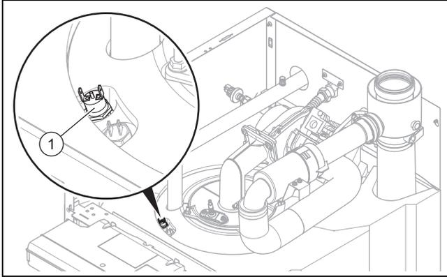
Wenn der Fehlercode **F.20** angezeigt wird, hat der Sicherheitstempereaturbegrenzer das Produkt wegen zu hoher Temperatur automatisch abgeschaltet.
