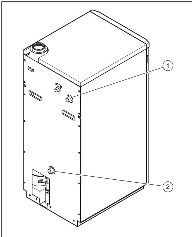
1. Schließen Sie den Heizungsvorlauf am Heizungsvorlauf-Anschluss (1) an.
