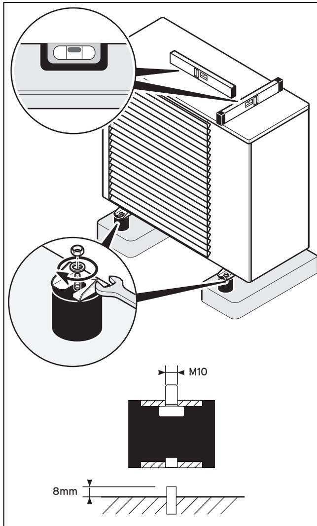
1. Verwenden Sie nur Schrauben mit einer bestimmten Länge.
