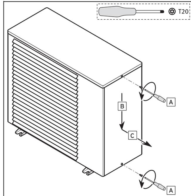
1. Entfernen Sie die beiden Schrauben (A).
