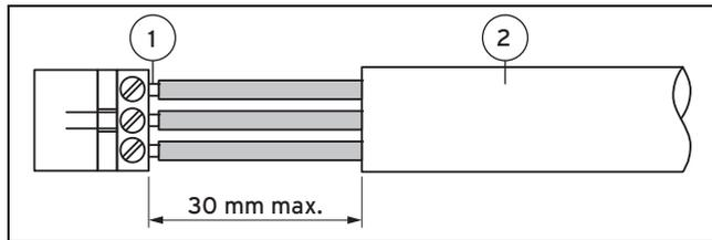
1 Anschlussdrähte 2 Isolierung
