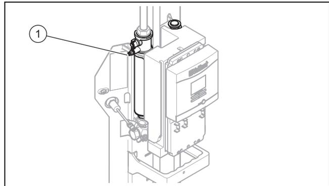
1. Öffnen Sie die Entlüfterschraube (1), bis Solarflüssigkeit heraustropft.
