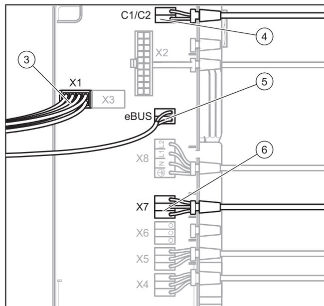
4. Führen Sie das Anschlusskabel der Legionellenschutzpumpe oder des Bypass-Umschaltventils mit der Kabeltülle durch die Öffnung im Reglergehäuse.
