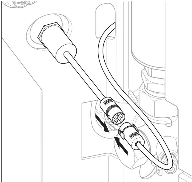
2. Beachten Sie, dass der am Speicher montierte Temperaturbegrenzer direkt in die Phase der Netzanschlussleitung eingebunden ist. Schalten Sie daher das Produkt spannungslos und verbinden Sie den Anschlussstecker des Produkts mit dem Anschlussstecker des werkseitig vormontierten Temperaturbegrenzers. Andernfalls ist das Produkt nicht ausreichend an das Stromnetz angeschlossen.
