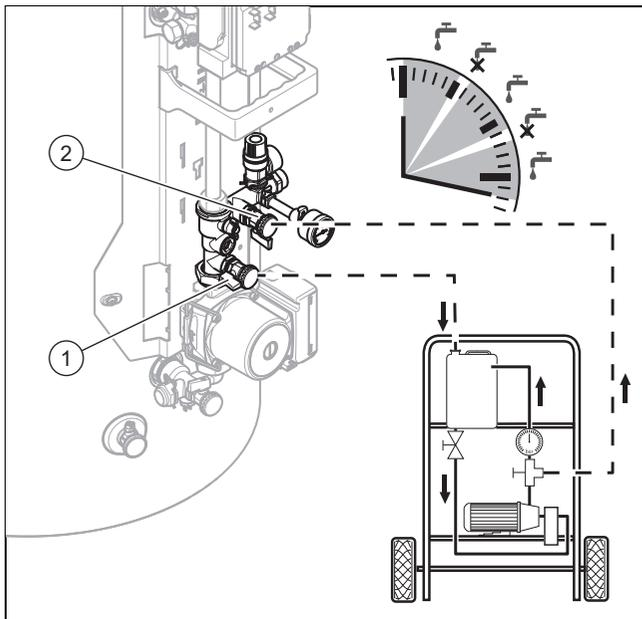
4. Verbinden Sie die Befülleinrichtung wie dargestellt mit dem Produkt.
