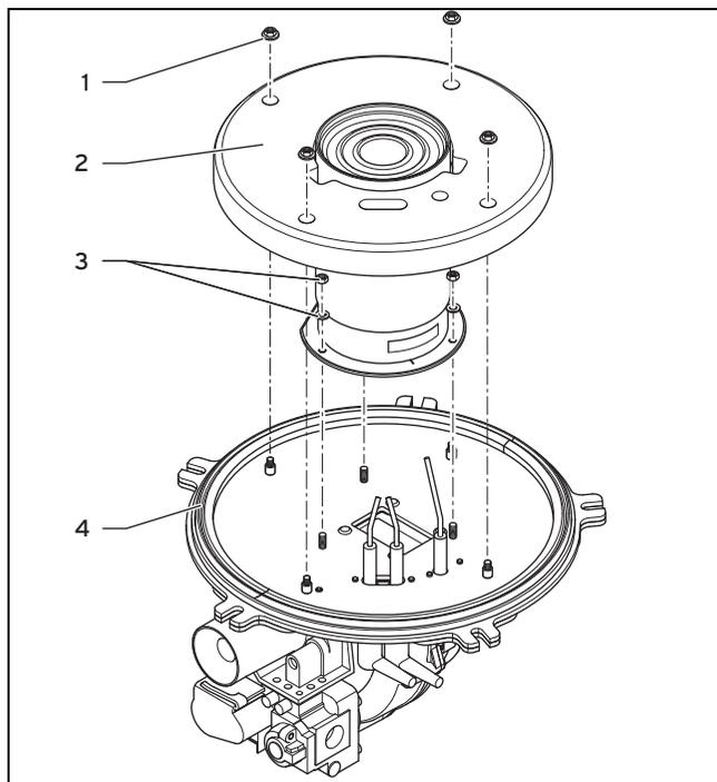
1. Prüfen Sie die Oberfläche des Brenners auf Beschädigungen. Wenn Sie Beschädigungen feststellen, dann tauschen Sie den Brenner inkl. Dichtung aus (→ Seite 33).
