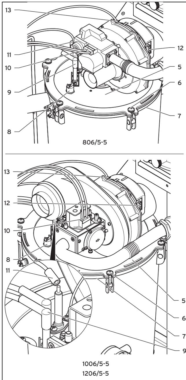
9. Ziehen Sie die Stecker (12) und (13) am Gebläsemotor ab, indem Sie die Rastnase eindrücken.
