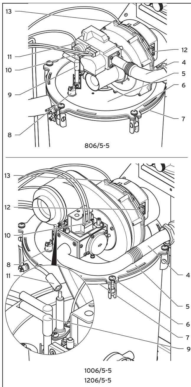
4. Stecken Sie den Gas-Luft-Verbund (5) auf den Wärmetauscher (7).
