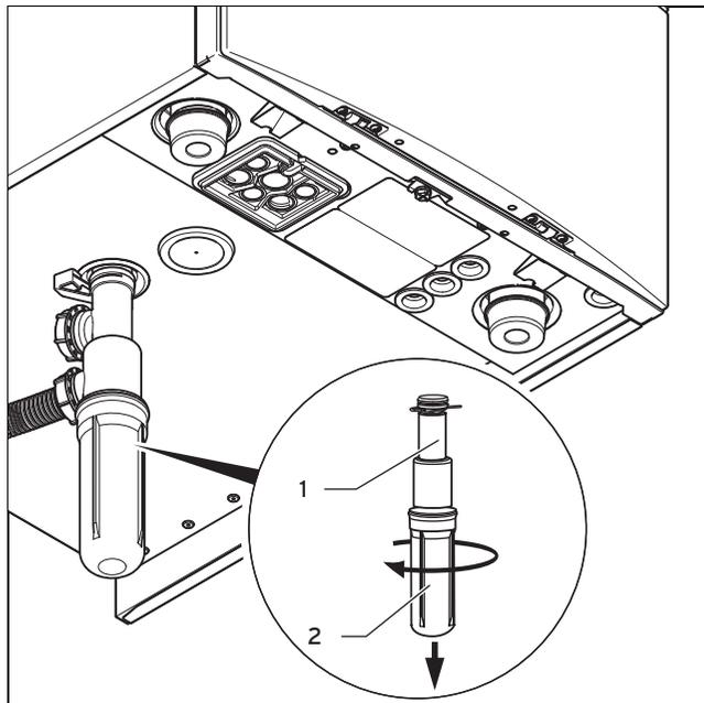
1. Nehmen Sie das Siphon-Unterteil (2) ab, indem Sie es vom Kondensatsiphon (1) abschrauben.
