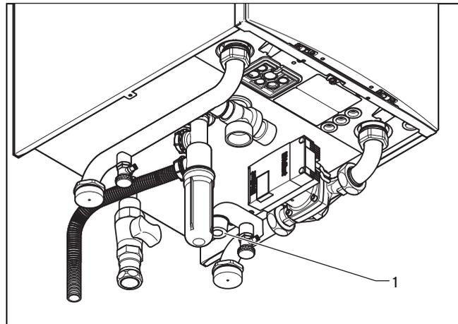
1. Installieren Sie am Anschluss im Rücklauf des Heizgerätekreises (**1**) sowie im Anlagenkreis je ein ausreichend dimensioniertes Ausdehnungsgefäß.
