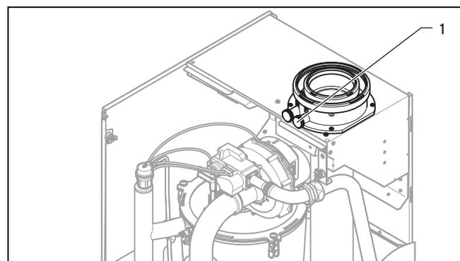
3. Messen Sie den CO<sub>2</sub>- und CO-Gehalt am Abgasmessstutzen (1).
