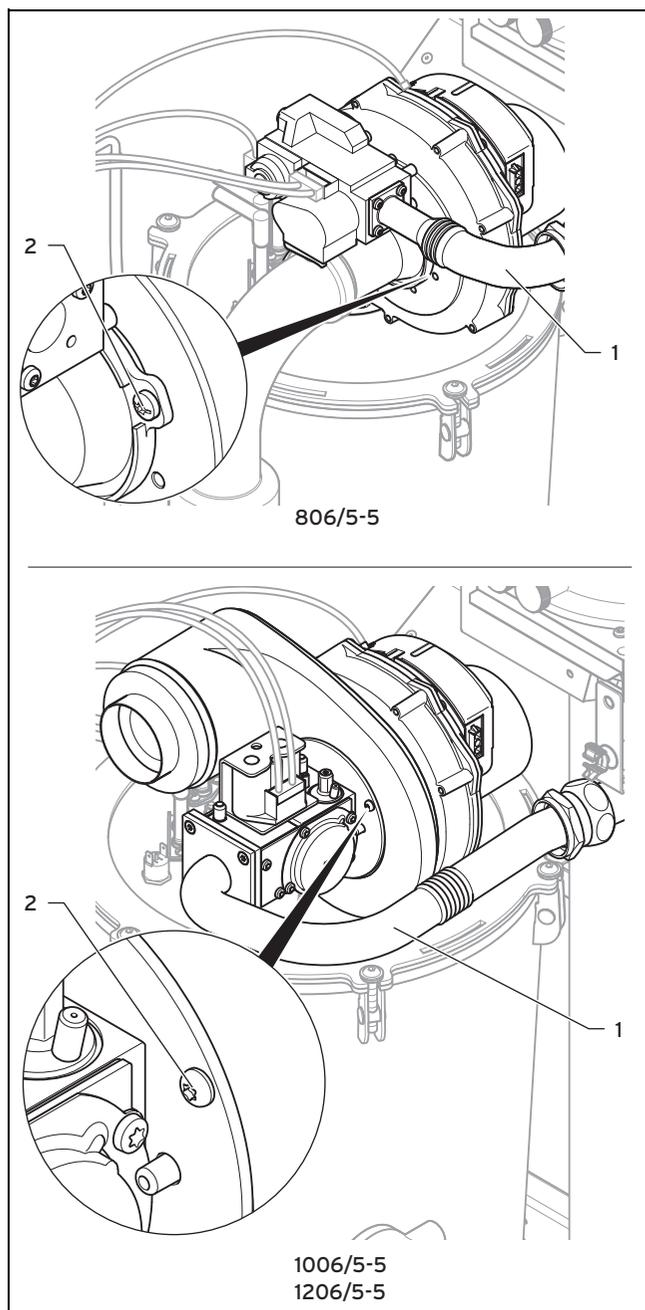
1. Demontieren Sie das Gasrohr (1) von der Gasarmatur.
