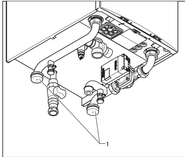
1. Legen Sie jeweils eine Flachdichtung in die Wartungshähne (Vaillant Zubehör) ein.
