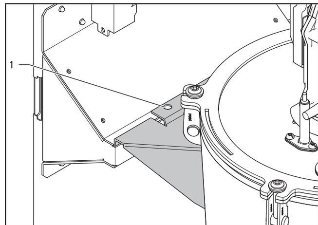
5. Entfernen Sie die Schrauben (1) an der Halterung des Wärmetauschers.
