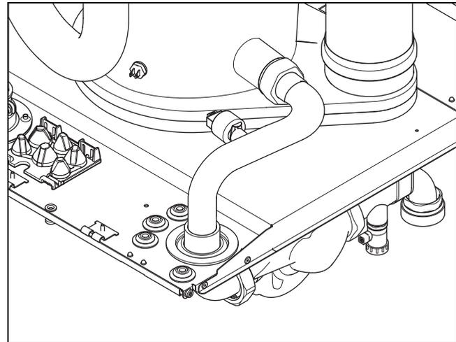
4. Lösen Sie die Dichtungsmanschetten des Vor- und Rücklaufrohrs aus dem Bodenblech.
