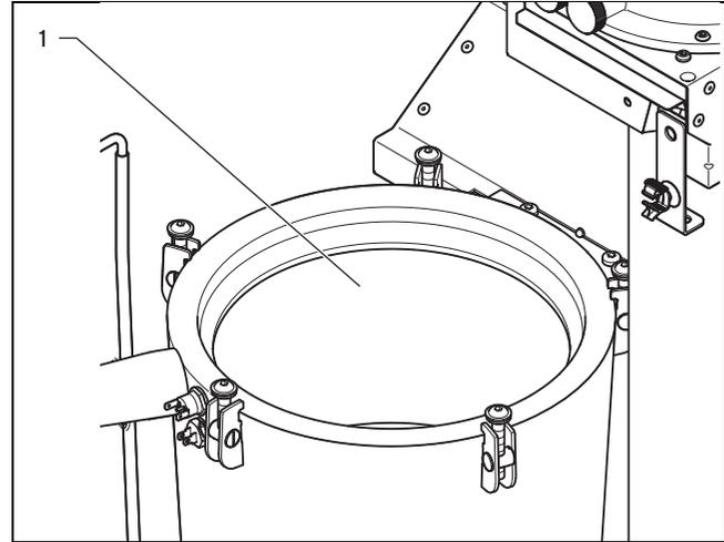
2. Demontieren Sie das Unterteil des Kondensatsiphons, damit eine ggf. vorhandene Neutralisationseinrichtung nicht beschädigt wird.
