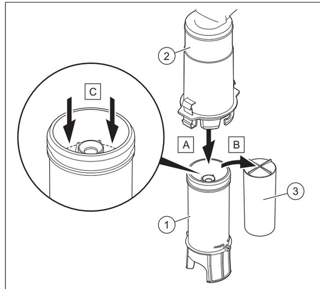
1. Rasten Sie das Unterteil des Siphons (1) aus dem Oberteil des Siphons (2) aus, ohne die Frontverkleidung des Produkts zu demontieren.
