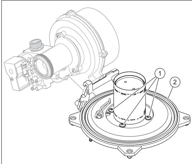
2. Lösen Sie die vier Schrauben (1) am Brenner.
