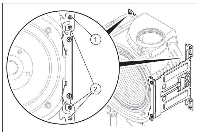
8. Entfernen Sie die unteren drei Schrauben (2) am hinteren Teil des Halters.
