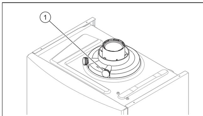
3. Schrauben Sie die Abdeckung vom Abgasmessstutzen (1) ab.
