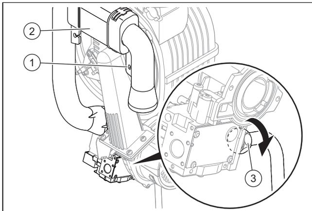
5. Drehen Sie die Halteschraube (1) heraus und nehmen Sie das Luftansaugrohr (2) vom Ansaugstutzen ab.
