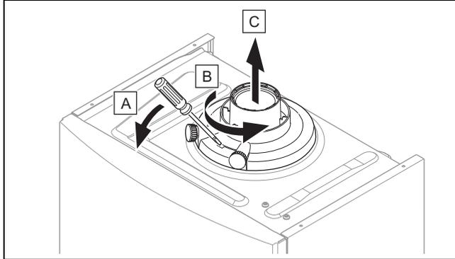
1. Stecken Sie einen Schraubendreher in den Spalt zwischen den Messpunkten.
