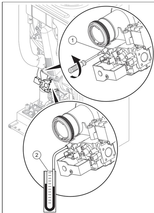
2. Lösen Sie mit einem Schraubendreher die Dichtungsschraube am Messnippel (1) der Gasarmatur.
