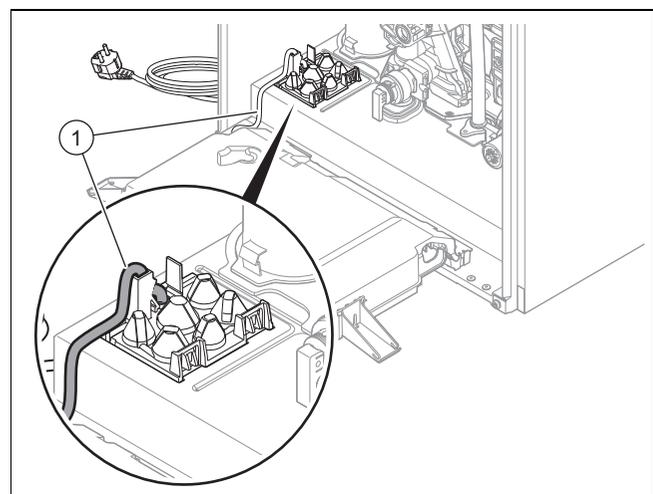
3. Verlegen Sie ein normgerechtes dreiadriges Netzanschlusskabel durch die Kabeltülle in das Produkt.
