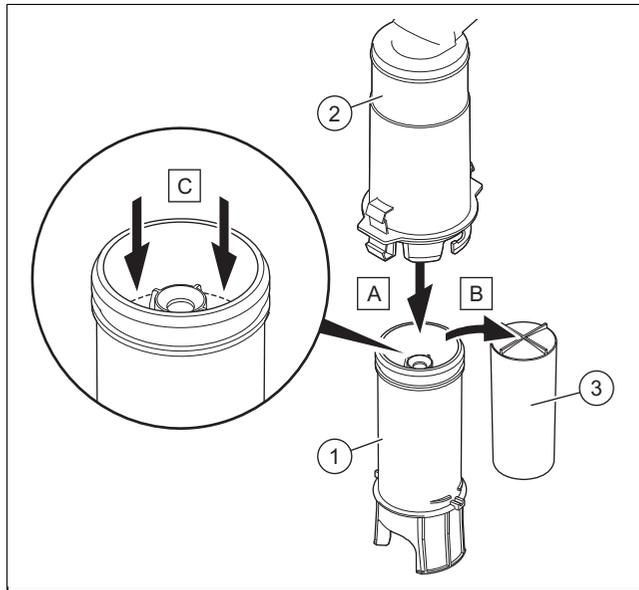
1. Rasten Sie das Unterteil des Siphons (1) aus dem Oberteil des Siphons (2) aus.
