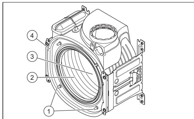
2. Lösen Sie nicht die vier Muttern der Gewindestifte (1), um die Dichtheit des Brenners bei der Montage zu gewährleisten.
