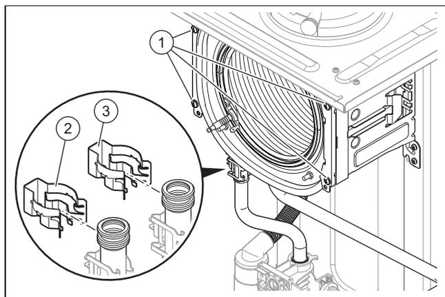
4. Entfernen Sie die Klammern (2) und (3) im Bereich des Vorlauf- und des Rücklaufanschlusses.
