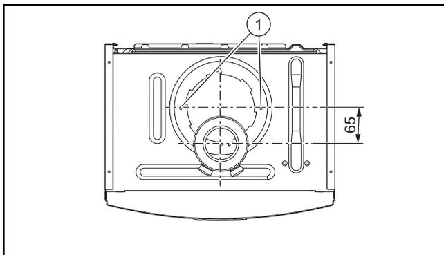
2. Setzen Sie das alternative Anschlussstück mit Versatz nach vorn ein.
