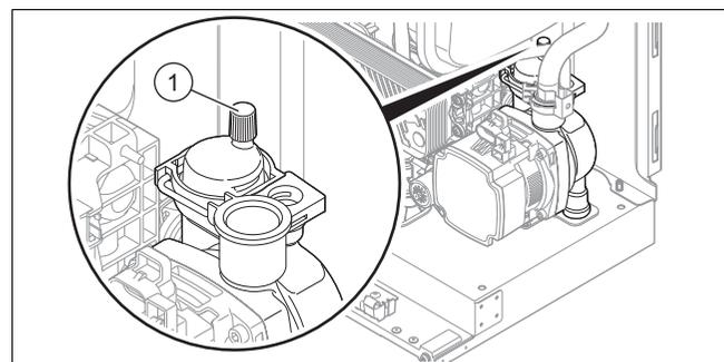
1. Lösen Sie die Kappe des Schnellentlüfters (1) um eine bis zwei Umdrehungen.
