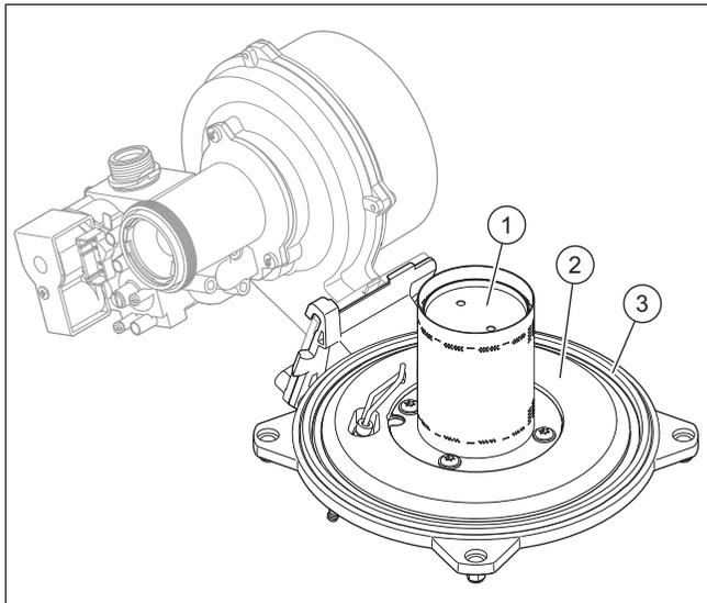
1. Prüfen Sie die Oberfläche des Brenners (1) auf eventuelle Beschädigungen. Wenn dies der Fall ist, tauschen Sie den Brenner aus.
