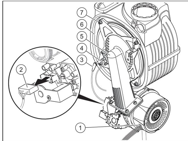
7. Ziehen Sie den Stecker der Zündleitung (3) und der Erdungsleitung (4) von der Zündelektrode ab.
