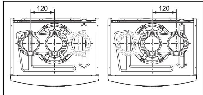
2. Setzen Sie das alternative Anschlussstück ein. Der Anschluss für die Luftzufuhr kann zur linken oder zur rechten Seite weisen. Achten Sie auf die Nasen.
