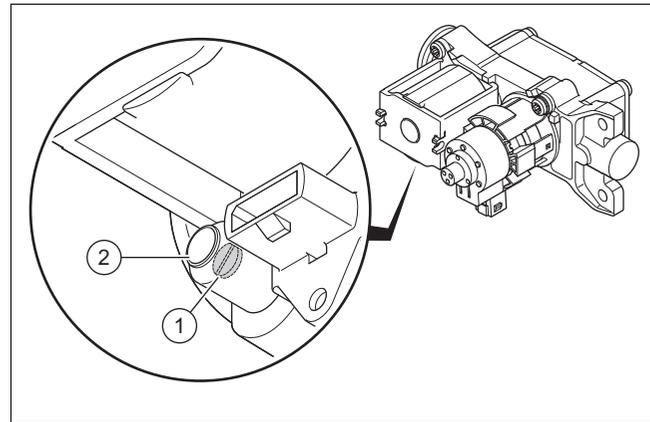
3. Lösen Sie die Prüfschraube (1).
