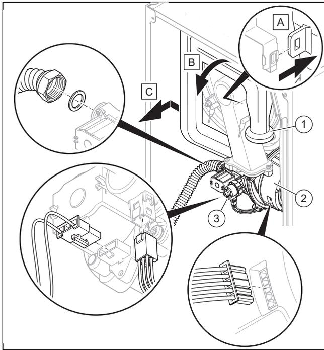
5. Ziehen Sie das Luftansaugrohr (1) aus dem oberen Halter heraus und nehmen Sie das Luftansaugrohr vom Ansaugstutzen ab, wie in der Abbildung dargestellt.
