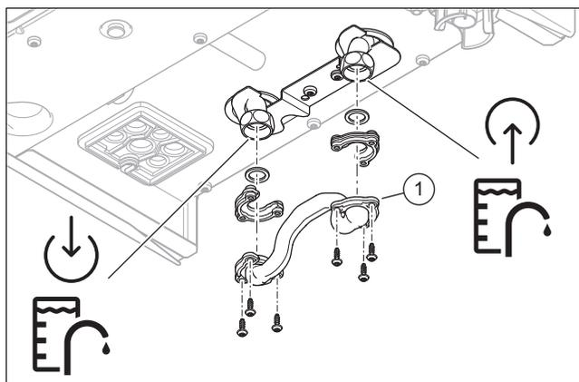
1. Demontieren Sie den Speicherbypass (1) zwischen Speichervorlauf und Speicherrücklauf.
