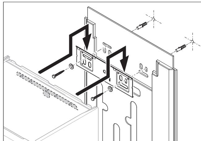
3. Hängen Sie das Produkt auf den Gerätehalter und achten Sie darauf, dass die Geräuschdämmung korrekt anliegt.
