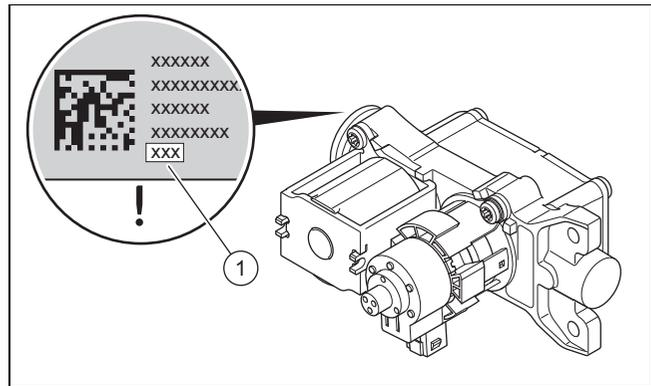
1. Lesen Sie den aufgedruckten Offset (1) von der Rückseite der Gasarmatur ab. Verwenden Sie z. B. einen Spiegel.
