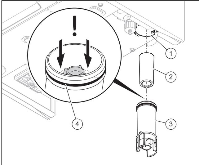
1. Lösen Sie das Siphon-Unterteil (3) vom Siphon-Oberteil (1).
