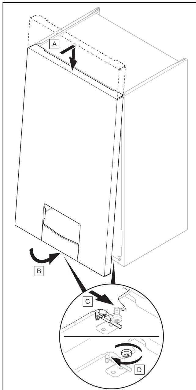
1. Montieren Sie die Frontverkleidung, wie in der Abbildung dargestellt.
