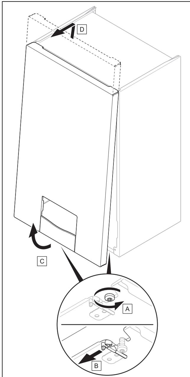
1. Lösen Sie die zwei Schrauben an der linken und rechten Unterseite des Produkts, ohne die Schrauben komplett herauszudrehen.
