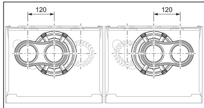
2. Setzen Sie das alternative Anschlussstück ein. Der Anschluss für die Luftzufuhr kann zur linken oder zur rechten Seite weisen. Achten Sie dabei auf die Rastnasen.
