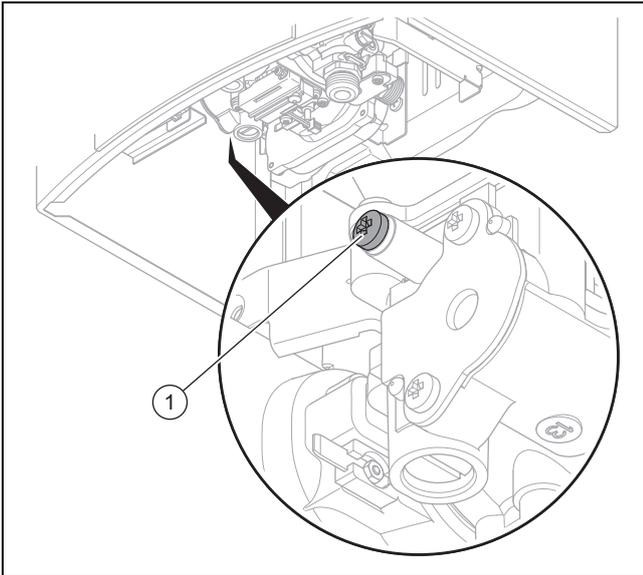
1. Drehen Sie den Temperaturwähler bis zum Anschlag im Uhrzeigersinn, um die Wassermenge zu verringern und die maximale Wassertemperatur einzustellen.
