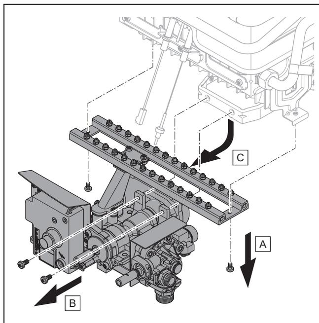
8. Ziehen Sie die Zündelectrode und die Überwachungselectrode, die an dem Schaltkasten angeschlossen sind, heraus.
