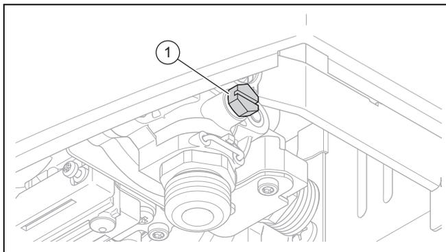
1. Lösen Sie die Entleerungsschraube (1) und den Dichtungsring für die Entleerung.
