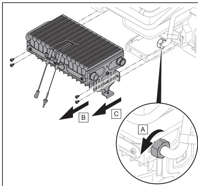
12. Schrauben Sie die Überwurfmutter des Wasseranschlusses des Wärmetauschers am Brenner ab.
