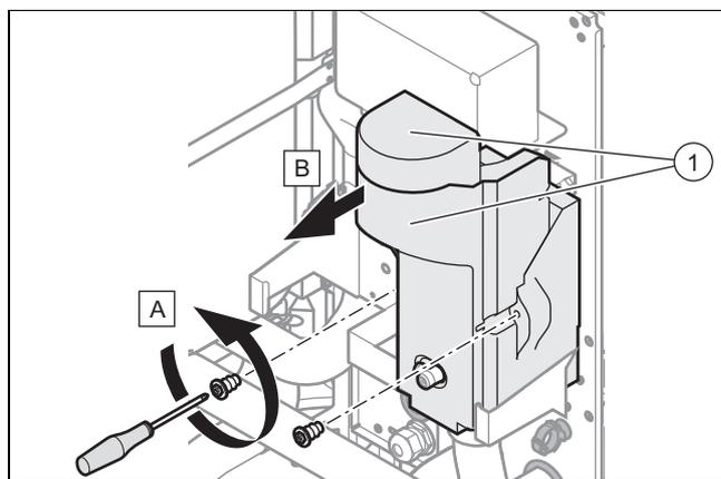
2. Entfernen Sie die Wärmedämmung (1) der Heizpatrone.
