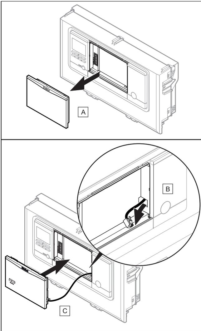
1. Entfernen Sie die Abdeckung des Schaltkastens und setzen Sie an dieser Stelle die Funkbasis ein.
