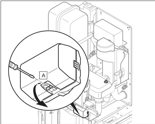
6. Entkoppeln Sie das Vorrangumschaltventil in der Mittelstellung mit Hilfe des Riegels (A).
