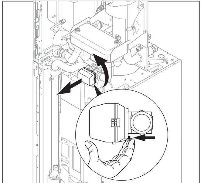
3. Drehen Sie den Motor um 1/8 Umdrehung in Pfeilrichtung.
