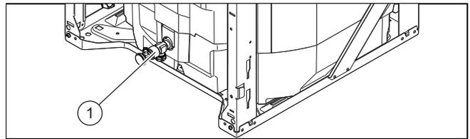
3. Schließen Sie einen Schlauch am Anschluss des Entleerungshahns (1) an und führen Sie das freie Ende des Schlauchs an eine geeignete Abflussstelle.
