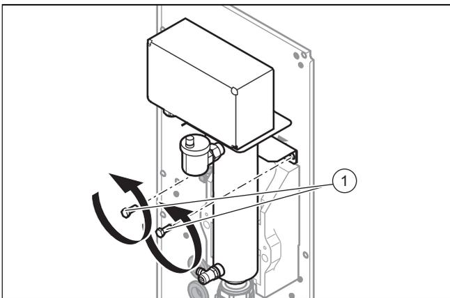
8. Trennen Sie die Heizpatrone durch Lösen der Schrauben (1) vom Kreislauf.
