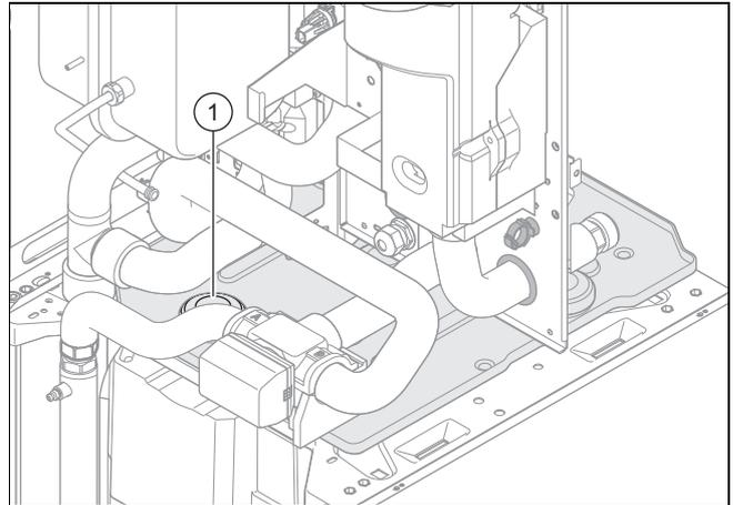
2. Entfernen Sie die Wärmedämmung an der Magnesiumschutzanode (1).
