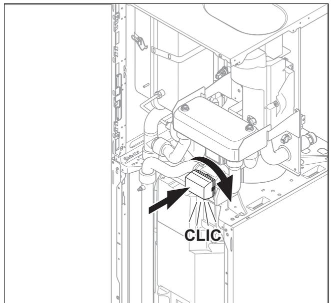
4. Montieren Sie den neuen Motor und drehen Sie ihn um 1/8-Umdrehung in Pfeilrichtung.
