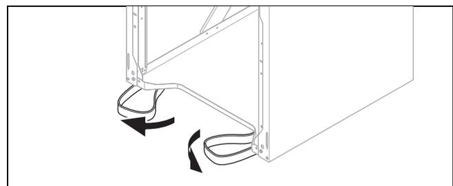
7. Schwenken Sie die unter dem Produkt befindlichen Trageschlaufen nach vorn.
