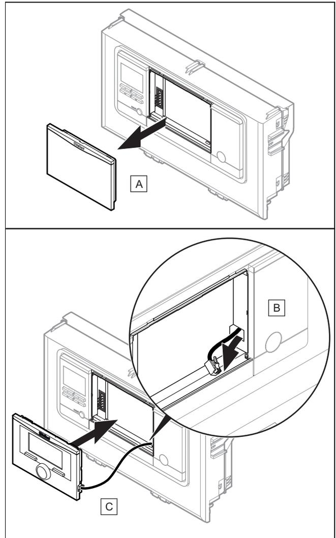
1. Entfernen Sie die Abdeckung des Schaltkastens.
