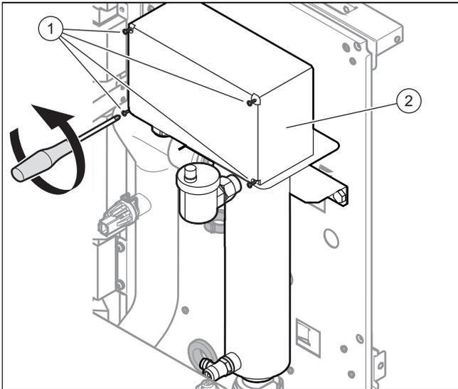
3. Lösen Sie die Schrauben (1) und entfernen Sie sie.
