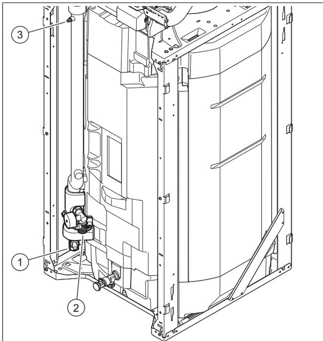
3. Schließen Sie je einen Schlauch an den Entleerungshähnen (1) und (2) an und führen Sie das freie Ende der Schläuche an eine geeignete Abflussstelle.
