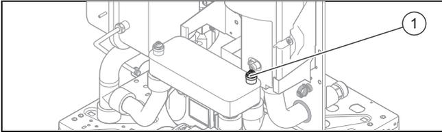
6. Öffnen Sie das rechte Entlüftungsventil **(1)** des Plattenwärmetauschers.
