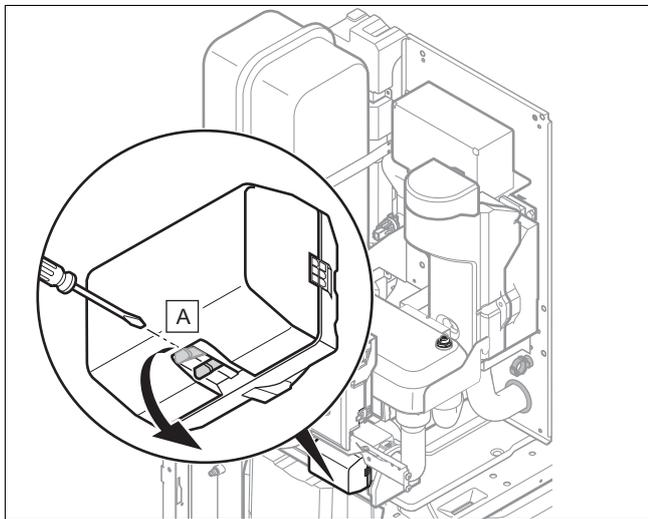
4. Bringen Sie das Vorrangumschaltventil durch manuelle Betätigung in die Mittelstellung (A).
