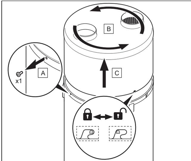
1. Drehen Sie die Schraube (A) am Ring des Produkts mit einem Torx-Schraubendreher um einige Millimeter heraus.
