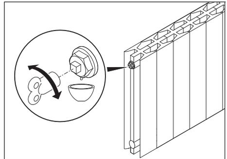
6. Entlüften Sie alle Heizkörper am vorgesehenen Anschluss (links oder rechts oben am Heizkörper).
