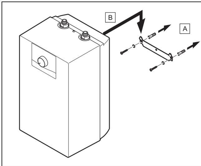
2. Befestigen das Produkt mit Hilfe des passenden Befestigungsmaterials wie auf der Abbildung gezeigt an der Wand.
