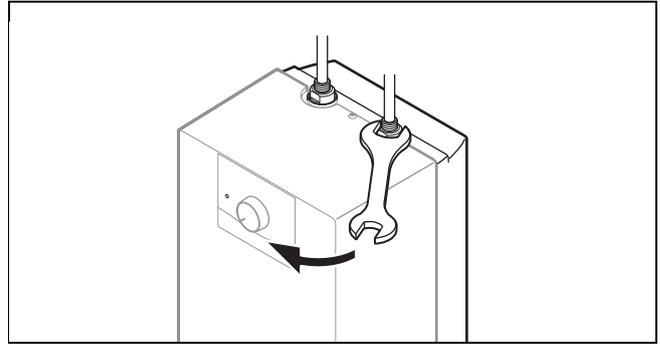
2. Schließen Sie das Produkt an der Armatur an.
