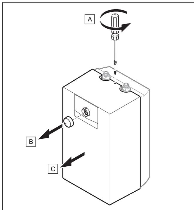
1. Lösen Sie (A) die Schraube zwischen den Hydraulikan schlüssen.
