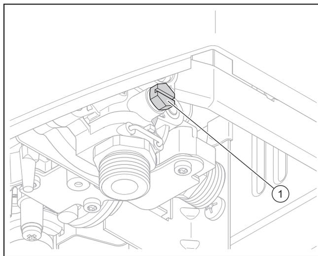
1. Schließen Sie das Gas-Absperrventil und das Absperrventil vor dem Kaltwassereingang.
