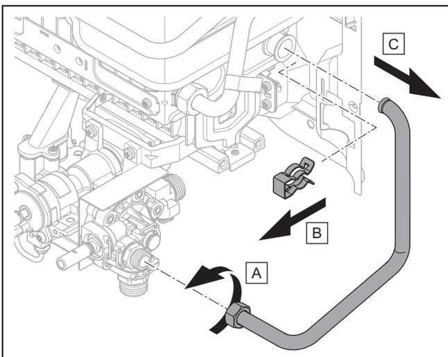
4. Schrauben Sie die Überwurfmutter am Wasserventil ab. Entfernen Sie den Clip am Kaltwasseranschluss des Brenners.
