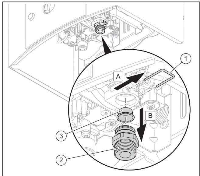
1. Entfernen Sie die Kaltwasseranschlussleitung vom Kaltwasseranschluss (2).
