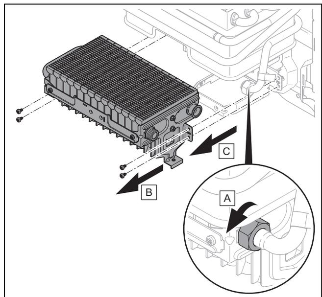
9. Schrauben Sie die Überwurfmutter des Wasseranschlusses des Wärmetauschers am Brenner ab.
