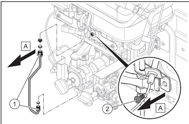
1. Schrauben Sie die Muttern **(1)** des Zündgasrohrs ab.
