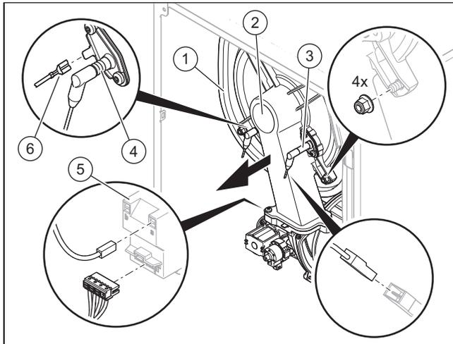
9. Ziehen Sie das Erdungskabel (6) von der Zündelektrode (4), die zwei Stecker vom Zündtransformator (5) und den Stecker des Kabels der Regelungselektrode (3) ab.
