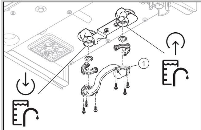
1. Demontieren Sie den Speicherbypass (1) zwischen Speichervorlauf und Speicherrücklauf.
