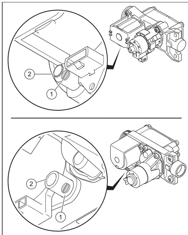
3. Lösen Sie die Prüfschraube (1).
