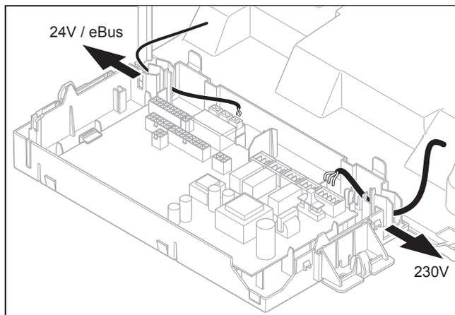
6. Verlegen Sie die Anschlusskabel der anzuschließenden Komponenten ordnungsgemäß im Schaltkasten.
