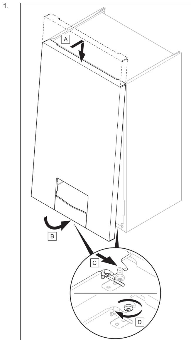
2. Schrauben Sie die zwei Schrauben an der linken und rechten Unterseite des Produkts fest.
