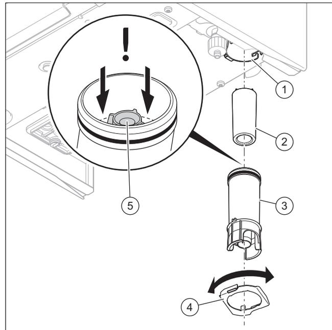
1. Lösen Sie den Sicherungsring (4).
