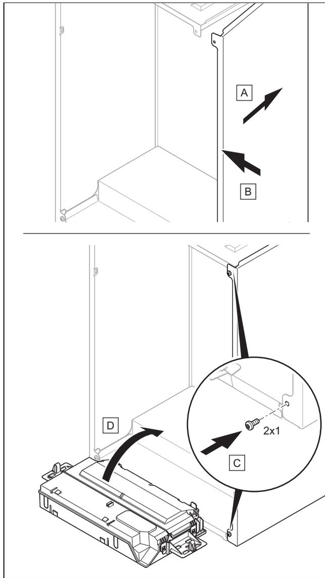
1. Wenn Sie die Seitenverkleidung demontiert haben, dann montieren Sie die Seitenverkleidung, wie in der Abbildung dargestellt.
