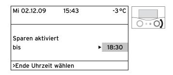
➤ Drehen Sie den rechten Einsteller ☐, bis die Uhrzeit eingestellt ist, zu der die Sparfunktion beendet werden soll.
