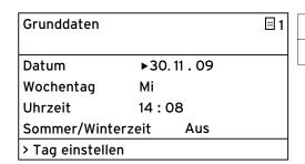
➤ Drücken Sie den rechten Einsteller 🖸 . Der geänderte **Tag** wird gespeichert.
