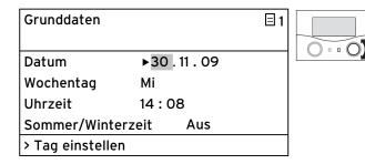
➤ Drehen Sie den rechten Einsteller [], bis der gewünschte **Tag** anzeigt wird.
