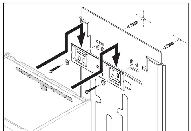
3. Hängen Sie das Produkt auf den Gerätehalter und achten Sie darauf, dass die Geräuschdämmung korrekt anliegt.
