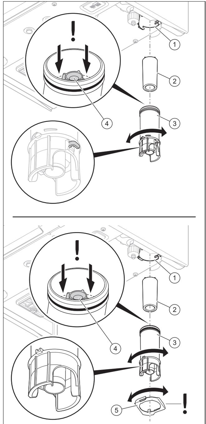
1. Lösen Sie ggf. den Sicherungsring (5).
