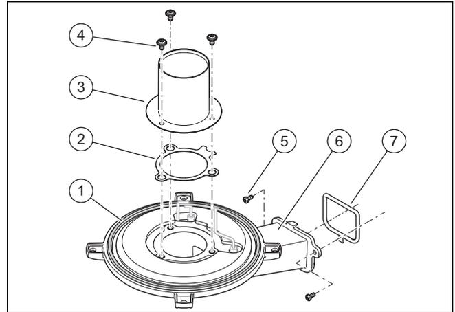
3. Schrauben Sie die zwei Schrauben (5) zwischen Brennerflansch (6) und Gebläse heraus.
