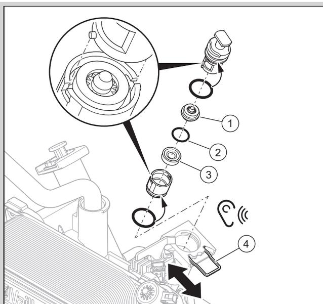
4. Ziehen Sie die Klammer (4) heraus in die Wartungsposition. Die Klammer ist gegen Herausfallen gesichert.
