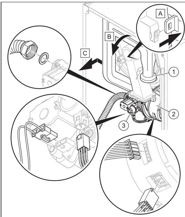
5. Ziehen Sie das Luftansaugrohr (1) aus dem oberen Halter heraus und nehmen Sie das Luftansaugrohr
