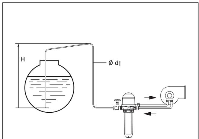
Die statische Saughöhe beträgt max. 3,0 m = Maximaler Ölstand höher als tiefster Punkt der Entnahmeleitung (Saugventil im Öl-Tank). Als Länge der Öl-Versorgungsleitung werden alle waagerechten und senkrechten Rohre sowie Bögen und Armaturen gerechnet.
