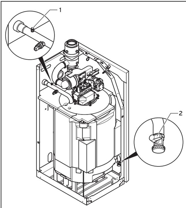
1 Entlüftungsnippel                      2 Kesselfüll- und Entleereinrichtung
