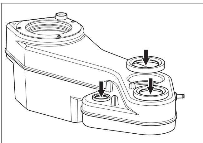
9. Erneuern Sie die Abgassammlerdichtungen nach jedem Ausbau.
