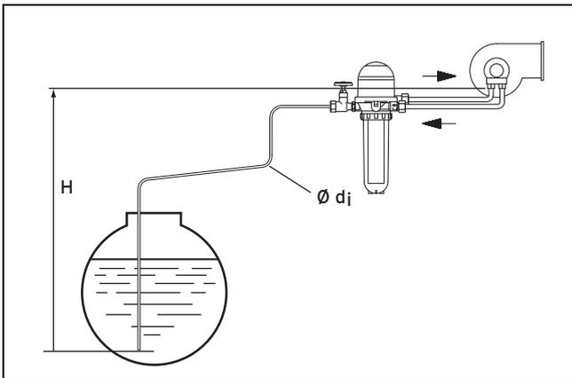
Die statische Saughöhe beträgt max. 3,0 m = senkrechter Abstand zwischen Öl-Pumpe am Brenner und Saugventil im Öl-Tank. Als Länge der Öl-Versorgungsleitung werden alle waagerechten und senkrechten Rohre sowie Bögen und Armaturen gerechnet.
