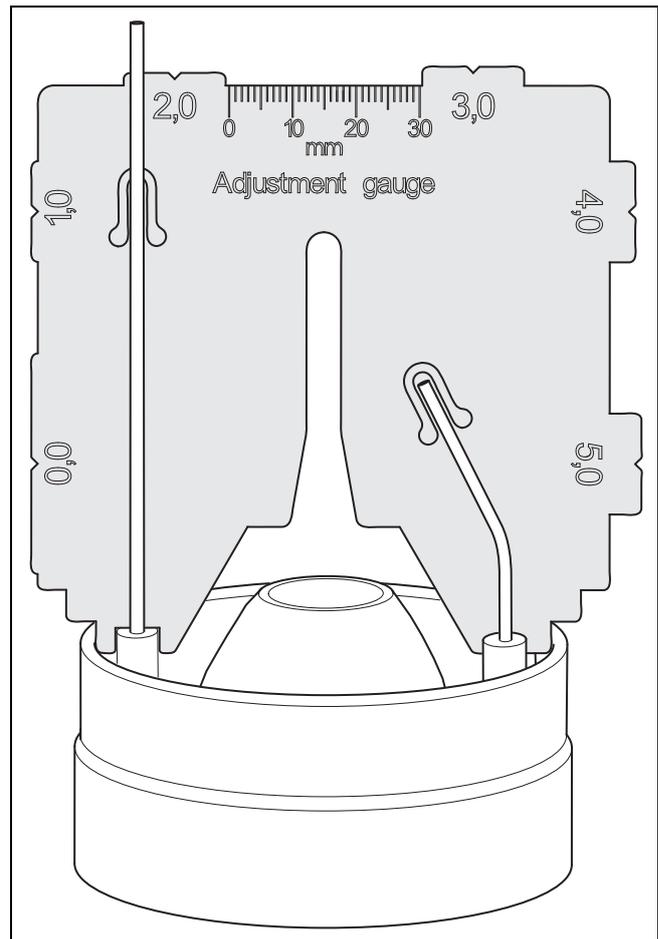
9. Kontrollieren Sie die korrekte Position der Elektroden mithilfe der Einstelllehre.
