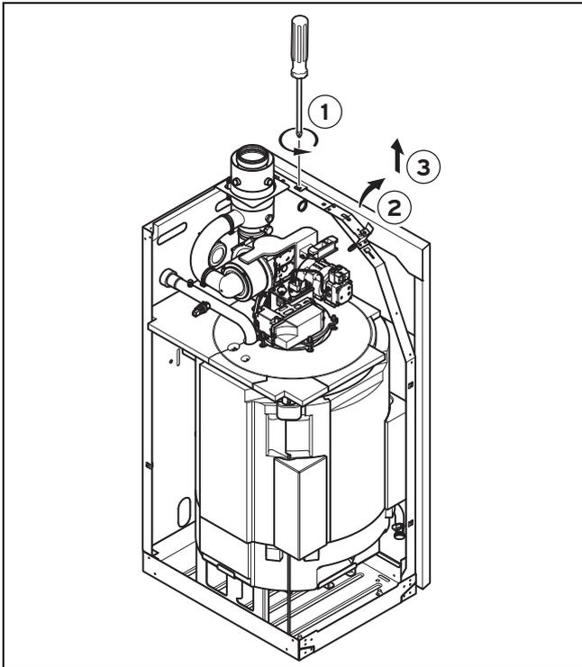
2. Lockern Sie die Schraube am Verkleidungsrahmen.
