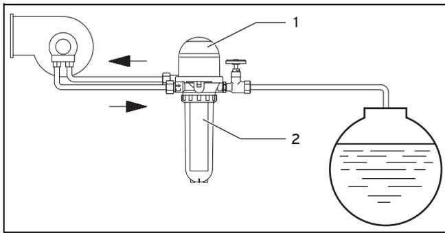
1. Installieren Sie den Heizöhlüfter **(1)** gemäß der Installationsanleitung.
