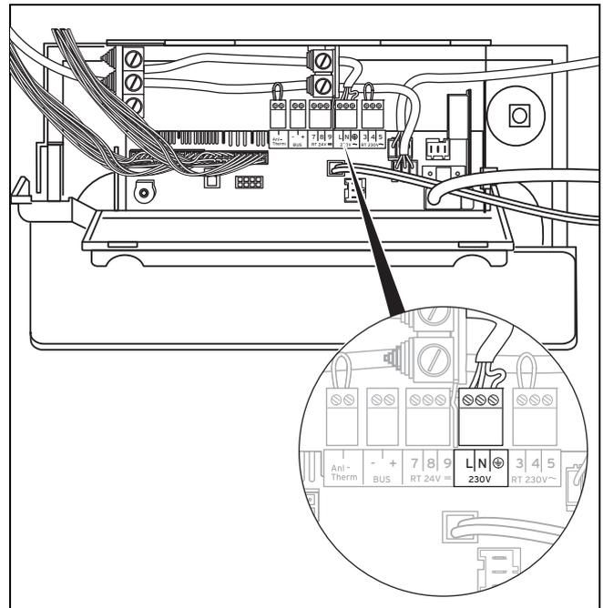
3. Verlegen Sie die Netzanschlussleitung durch das Gerät zum Schaltkasten.
