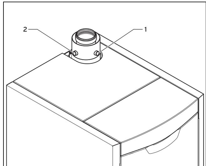
2. Schrauben Sie die Verschlusskappe von dem Prüfstutzen Abgas (1) ab.
