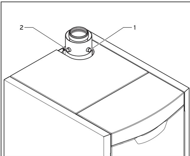
4. Schrauben Sie die Verschlusskappe vom Prüfstutzen Abgas **(1)** ab.
