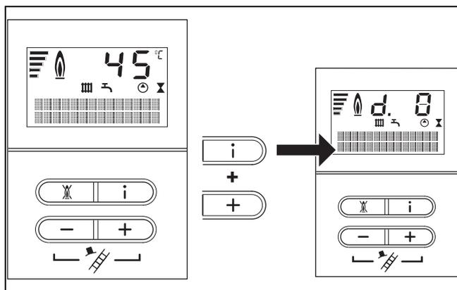
1. Drücken Sie gleichzeitig die Tasten „i“ und „+“ unterhalb des Displays.
