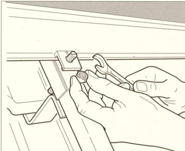
Bild 3.13 Den Kollektor an der Unterkante und Oberkante mit Befestigungsklemme so an Montageschiene fixieren, dass eingprägter Pfeil zum Kollektor zeigt.
