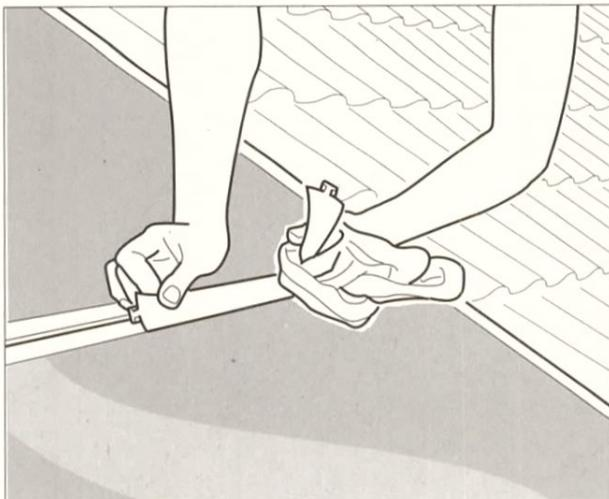
Bild 3.17 In die Spalte zwischen zwei Kollektoren Silikon-T-Profil einschieben oder drücken.
