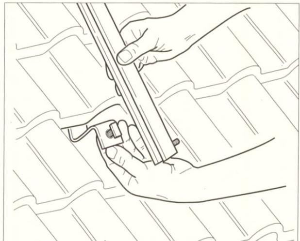
**Bild 3.10** Montageschienen auf gleiche Höhe ausrichten und so mit Schrauben an Sparrenankern befestigen, dass der Hammerkopf beim Festziehen quer in der Schiene sitzt.
