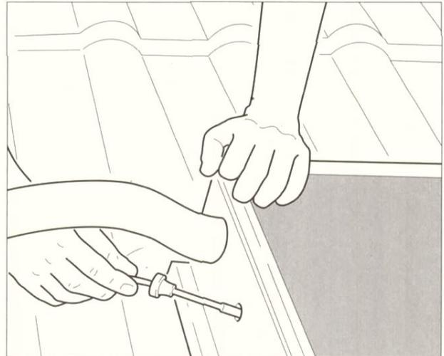
Bild 3.18 Stopfen aus Fühlerhülse nahe Kollektorfeld-Austritt ziehen und auf Fühler schieben. Fühler in Absorber-Hülse stecken und wieder verschließen. Kabel durch Lüfterziegel zur Fühlerdose legen.
