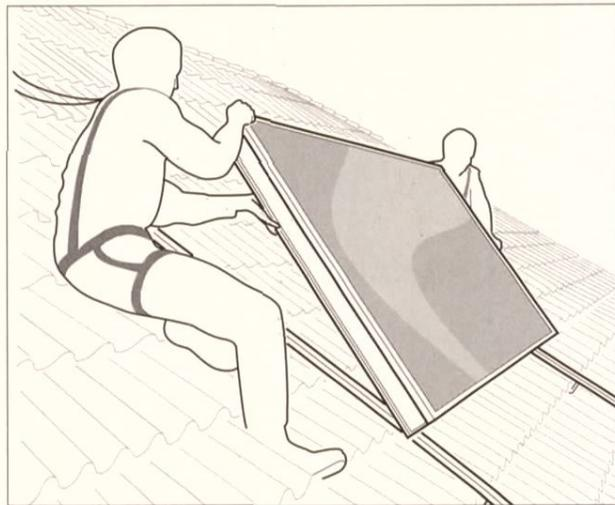
**Bild 3.12** Kollektor an den unteren beiden Schraubbolzen auf den Montageschienen absetzen.
