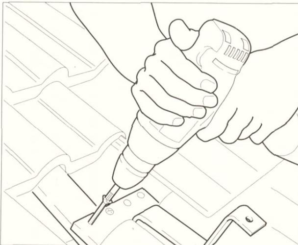
Bild 3.9 Sparrenanker mit Spax-Schrauben (6x80) befestigen. Wenn die Dachlatten stärker als 30 mm sind, dann die Sparrenanker entsprechend unterfüllen.
