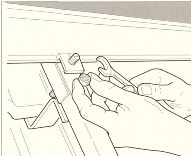
**Bild 3.13** Den Kollektor an der Unterkante und Oberkante mit Befestigungsklemme so an Montageschiene fixieren, dass eingepprägter Pfeil zum Kollektor zeigt.
