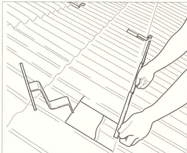
Bild 3.8 Kollektorfeld auf dem Dach ausmessen und entsprechende Befestigungspunkte auf den Sparren freilegen.
