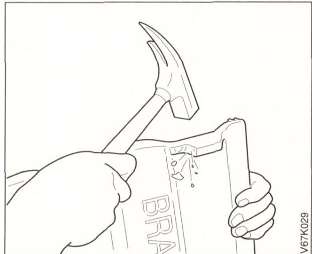
Bild 4.28 Wenn Sie die Ziegel auf Seitenbleche legen ggf. eine Einhängenocke abschlagen, Ziegel durchbohren und auf Latte (nicht auf dem Blech) festschrauben.
