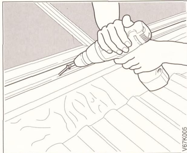
Bild 4.6 Jeden Kollektor am unteren und oberen Rand mit selbstschneidenden Spaxschrauben befestigen.
