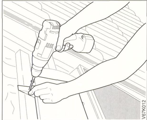
Bild 4.12 Holzauflage befestigen. Zwischen beiden Teilen der Holzauflage Abstand von ca. 20 cm halten.
