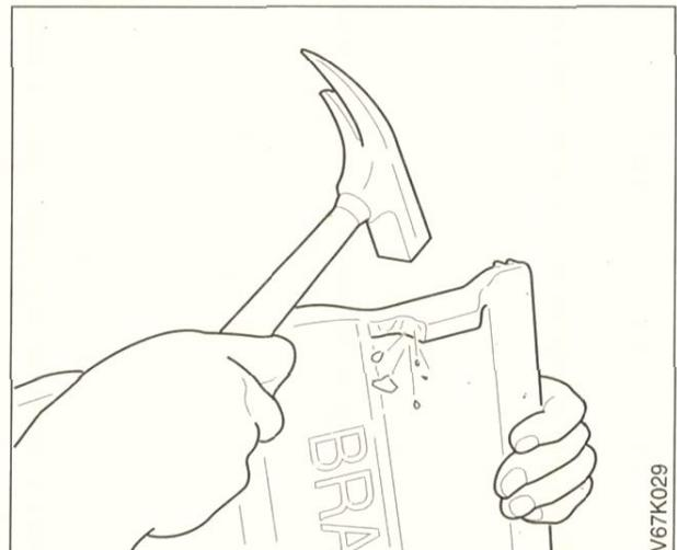
Bild 4.28 Wenn Sie die Ziegel auf Seitenbleche legen ggf. eine Einhangnokie abschlagen, Ziegel durchbohren und auf Latte (nicht auf dem Blech) festschrauben.
