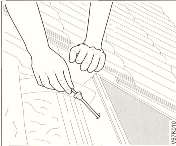
Bild 4.11 Solarfühler in Fühlerhülse am Kollektoraustritt stecken. Gummistopfen auf Kabel schieben und damit Öffnung verschließen. Kabel ins Dach führen.
