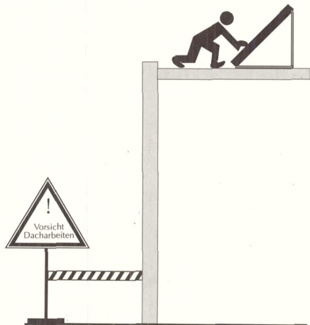
Bild 2.2 Schutz vor herabfallenden Gegenständen durch Absperrn. Verkehrswege mit Band und Hinweisschild sichern
