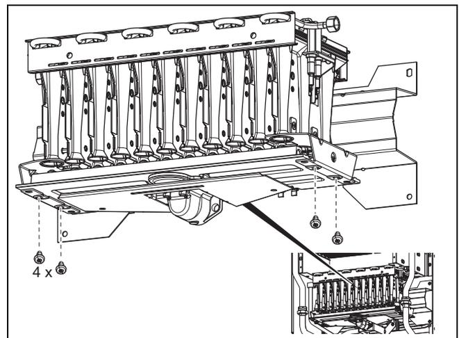
5. Ziehen Sie den Brenner mit Düsenplatte nach vorne heraus.
