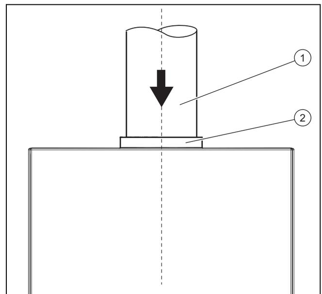
2. Setzen Sie das Abgasrohr (1) in den Abgasanschluss (2) ein.
