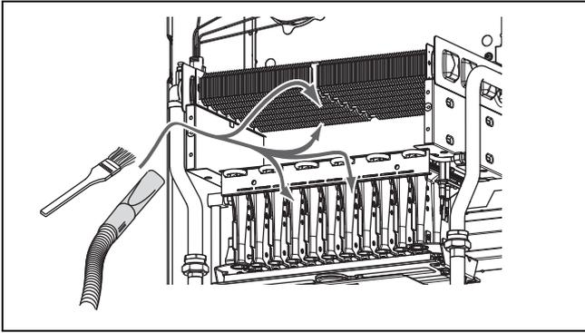
1. Reinigen Sie Brenner und Primär-Wärmetauscher mit einem Pinsel und einem Staubsauger von Verbrennungsrückständen.
