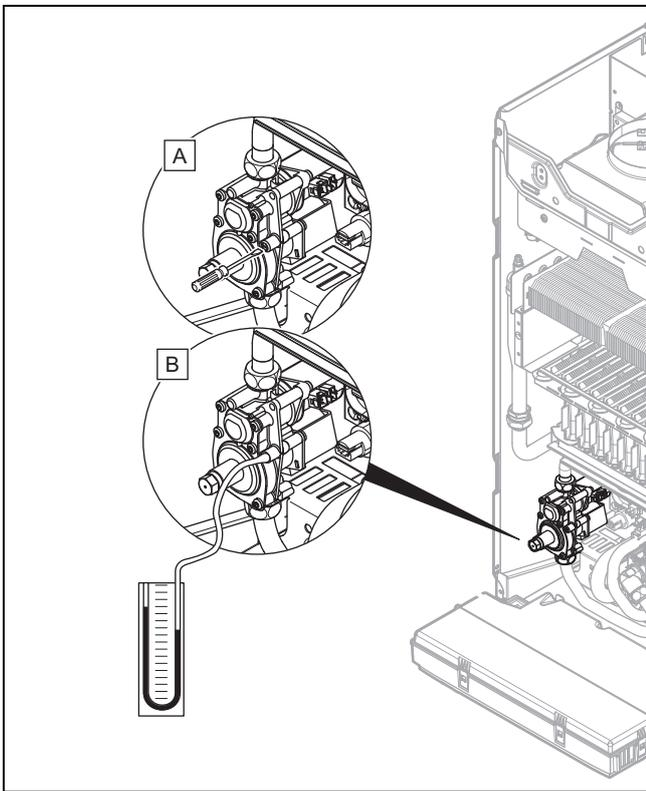
3. Lösen Sie mit einem Schraubendreher die Dichtungsschraube am Messanschluss der Gasarmatur.
