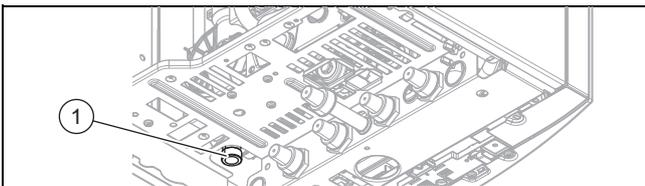
1. Montieren Sie das Ablaufrohr an den Auslauf (1) des Sicherheitsventils.
