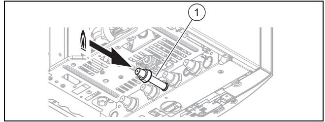
2. Installieren Sie die Gasleitung normgerecht an den Gasanschluss (1).
