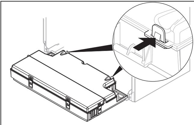
2. Lösen Sie die Clips am hinteren Deckel der Elektronikbox.
