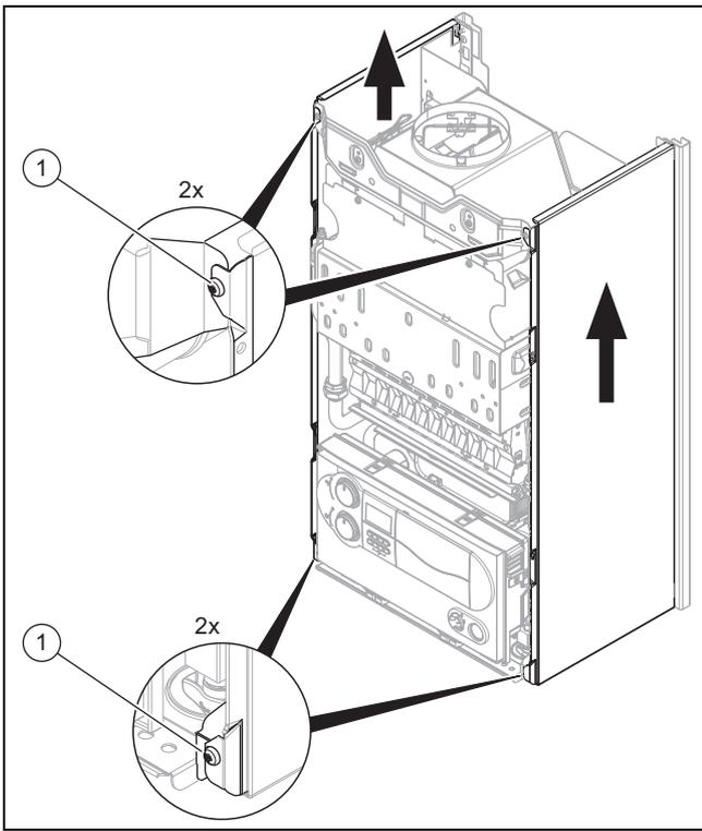
2. Lösen Sie die Schrauben (1).
