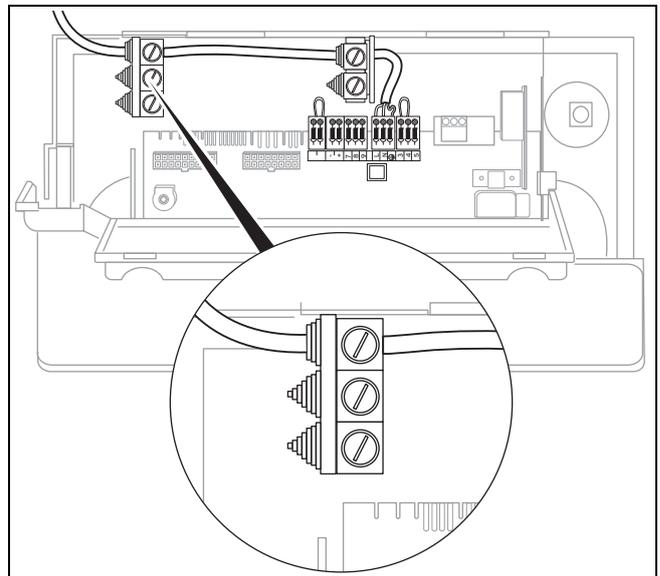
4. Führen Sie die Netzanschlussleitung durch den oberen Kabelkanal in die Elektronikbox.
