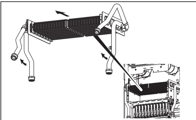
3. Demontieren Sie das obere Vorlauf- und Rücklaufrohr, indem Sie es ca. 90° nach oben drehen und abziehen.
