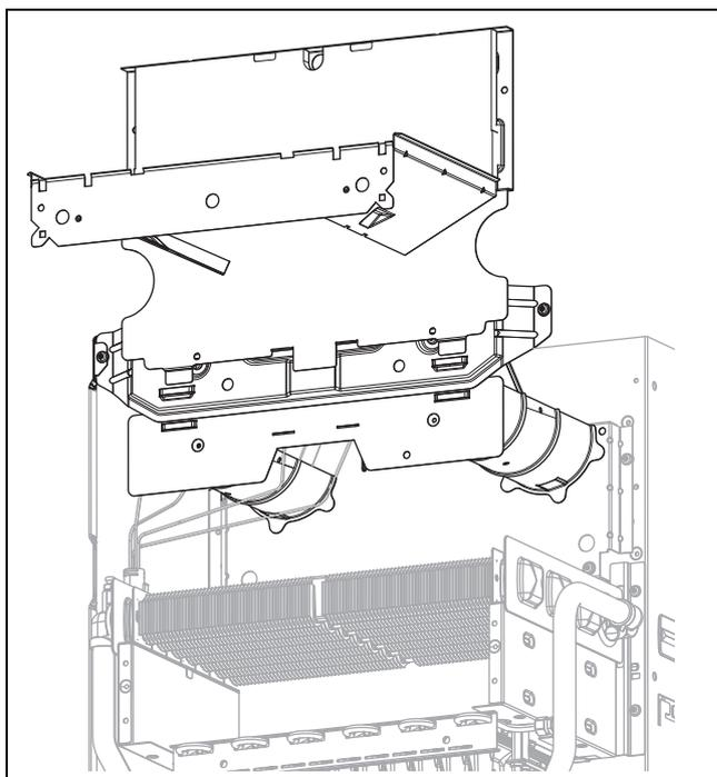
2. Entfernen Sie das Blech der Strömungssicherung.
