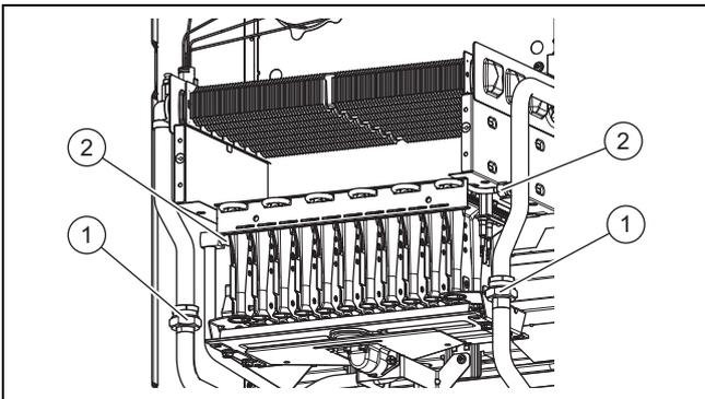
1. Lösen Sie die Verschraubungen am Vorlauf- und Rücklaufrohr (1).
