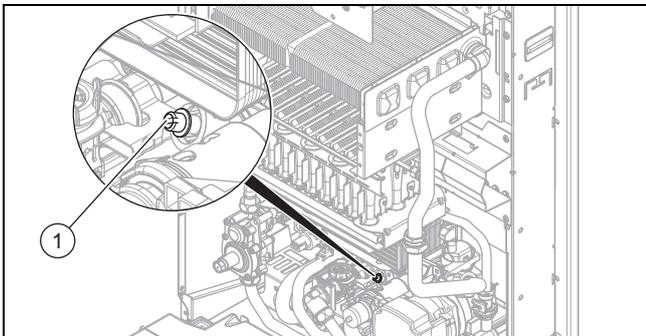
3. Regulieren Sie den Druck an der Einstellschraube (1).
