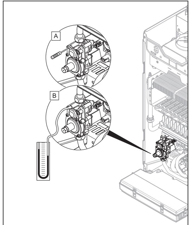
3. Lösen Sie die Dichtungsschraube.
