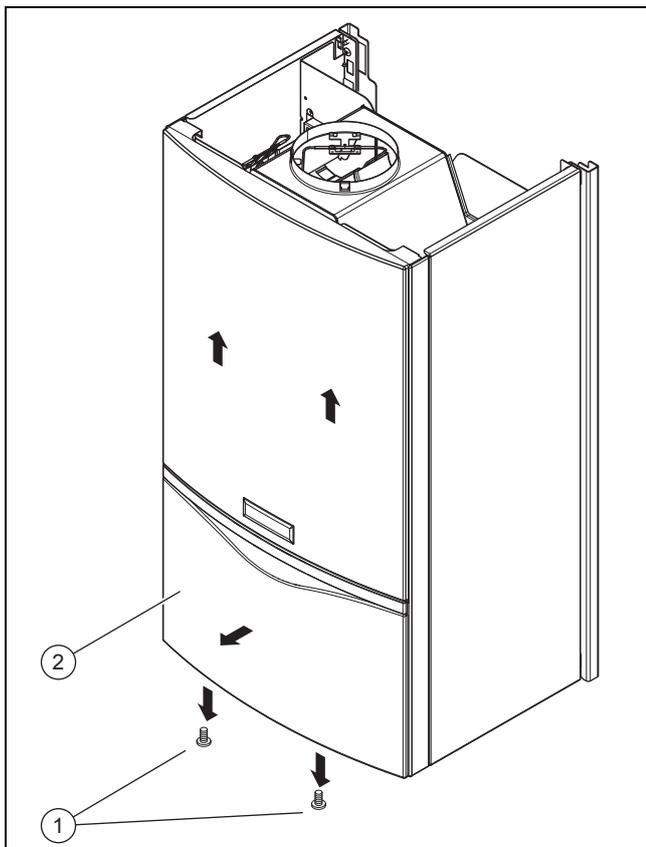
1. Lösen Sie die beiden Schrauben (1).
