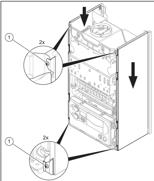
1. Setzen Sie die Seitenverkleidung auf die hinteren Haltefaschen auf.
