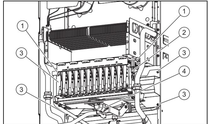
1. Lösen Sie die Verschraubung der Kühlrohre rechts und links am Brenner (1).
