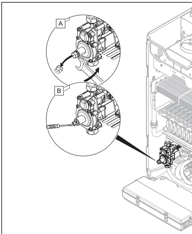
8. Schrauben Sie den Sechskant des Gasdruckreglers der Gasarmatur ab.
