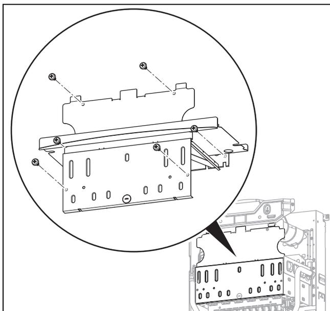
1. Entfernen Sie die 6 Schrauben am Blech der Strömungssicherung.
