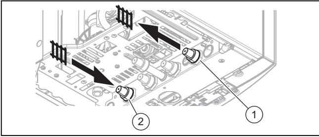
1. Installieren Sie den Heizungsvorlauf (1) und den Heizungsrücklauf (2) normgerecht.
