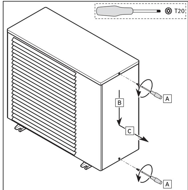
1. Entfernen Sie die beiden Schrauben (A).
