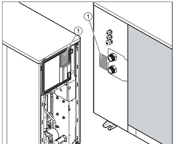
Die Typenbezeichnung und die Seriennummer befinden sich auf dem Typenschild (1).
