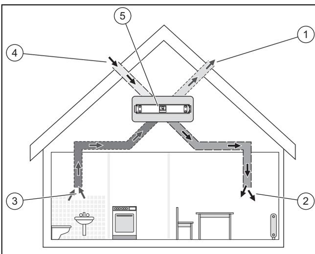
Das Produkt (5) ist der zentrale Bestandteil einer kontrollierten Wohnraumlüftung. Über Zuluftöffnungen (2) wird frische Außenluft (4) den Wohn- und Schlafräumen zugeführt. Die verbrauchte Luft aus Küche, Bad und WC wird über die Abluftöffnungen (3) in die Peripherie (1) abgeführt.
