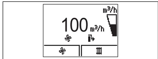
Im normalen Betriebszustand sehen Sie im Display die Grundanzeige. Die Grundanzeige zeigt den aktuellen Zustand des Produkts. Wenn das Display abgedunkelt war, wird durch den ersten Tastendruck zunächst die Beleuchtung eingeschaltet. Um die Tastenfunktion auszulösen, müssen Sie in diesem Fall die Taste erneut drücken.
