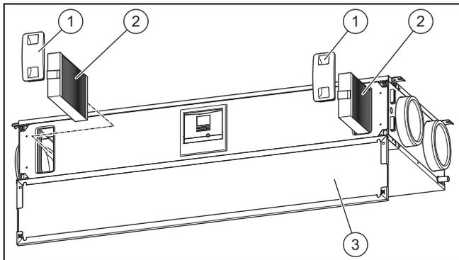
1. Öffnen Sie die Frontklappe (3).
