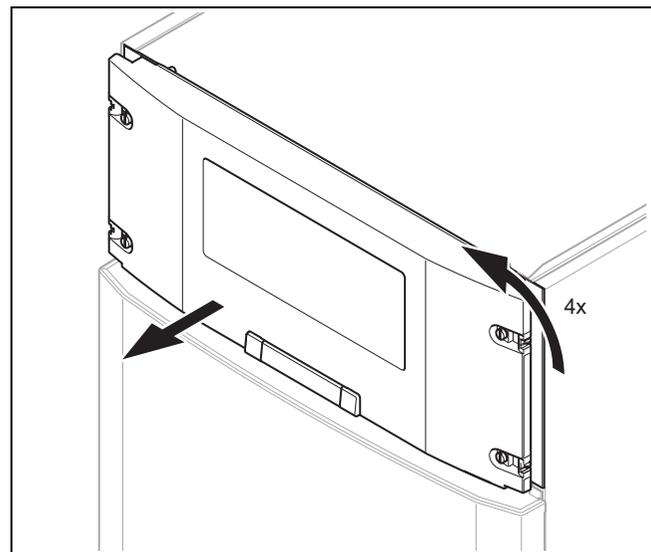
2. Drehen Sie die vier Schrauben jeweils um eine Vierteldrehung und ziehen Sie die Abdeckung des Bedienfelds nach vorn ab.
