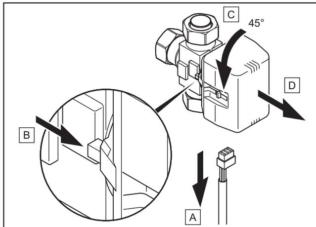
14. Ziehen Sie das Stromversorgungskabel am Motorkopf des Umschaltventils ab.
