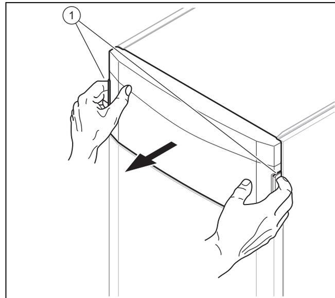
1. Demontieren die Frontklappe des Bedienfelds, indem Sie mit beiden Händen in die Griffmulden fassen und die Frontklappe nach vorn abziehen.
