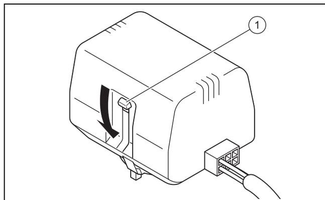
3. Drücken Sie den weißen Umschalthebel (1) am Motorkopf des Umschaltventils bis zum Einrasten in seine Mittelstellung, um das Umschaltventil Heizung/Speicherladung in Mittelstellung zu bringen.
