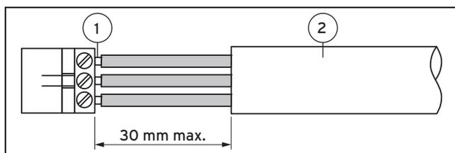
1 Anschlussdrähte 2 Isolierung
