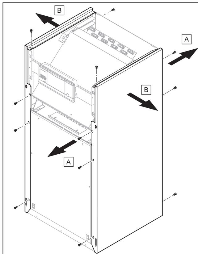
2. Drehen Sie 4 Schrauben vorn und 3 Schrauben hinten zur Demontage einer Seitenverkleidung heraus.
