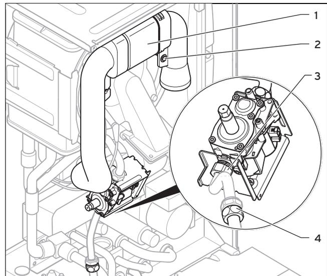
5. Drehen Sie die Halteschraube (2) heraus und nehmen Sie das Luftansaugrohr (1) vom Ansaugstutzen ab.
