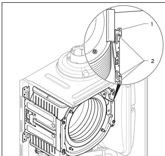
8. Entfernen Sie die unteren drei Schrauben **(2)** am hinteren Teil des Halters.
