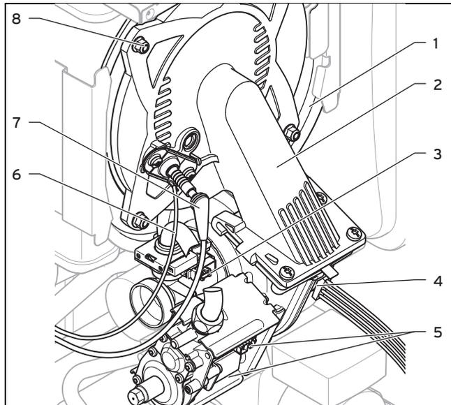
1. Stecken Sie das Thermo-Kompaktmodul (2) auf den Wärmetauscher (1).
