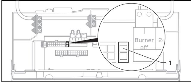
3. Wenn Sie die Leiterplatte tauschen, dann ziehen Sie den Kodierwiderstand (1) (Stecker X24) auf der alten Leiterplatte ab und stecken Sie den Stecker auf die neue Leiterplatte auf.
