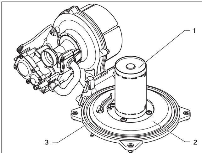
1. Prüfen Sie die Oberfläche des Brenners (1) auf Beschädigungen. Wenn Sie Beschädigungen feststellen, dann tauschen Sie den Brenner aus.
