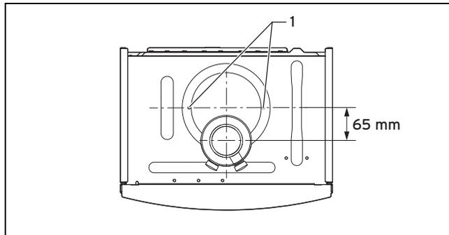
2. Setzen Sie das alternative Anschlussstück mit Versatz nach vorn ein.
