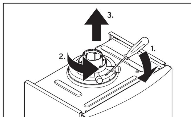
1. Stecken Sie einen Schraubendreher in den Schlitz zwischen den Messstutzen.
