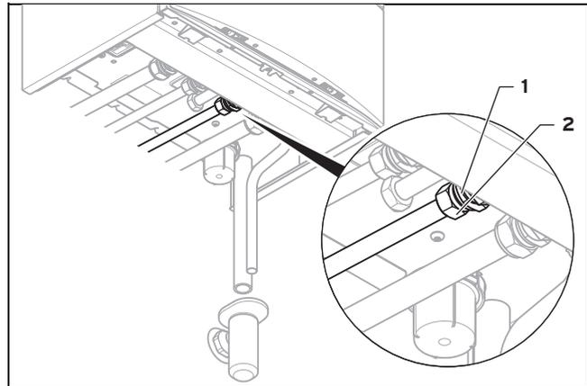
1. Schließen Sie das Kaltwasser-Absperrventil.
