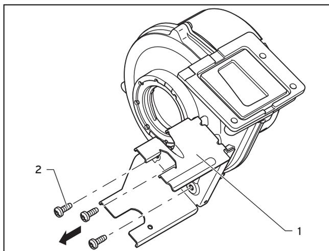
11. Demontieren Sie den Halter (1) der Gasarmatur vom Gebläse, indem Sie drei Schrauben (2) herausschrauben.
