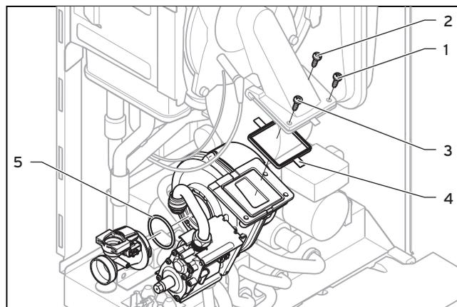
13. Bauen Sie die Komponenten in umgekehrter Reihenfolge wieder ein. Verwenden Sie dabei unbedingt neue Dichtungen (4) und (5). Beachten Sie die Anschraubreihenfolge der drei Schrauben zwischen Gebläse und Gemischrohr entsprechend der Nummerierung (1), (2) und (3).
