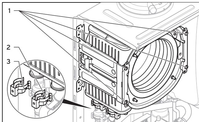
4. Ziehen Sie die Klammern **(2)** und **(3)** am Vorlaufanschluss und am Rücklaufanschluss ab.
