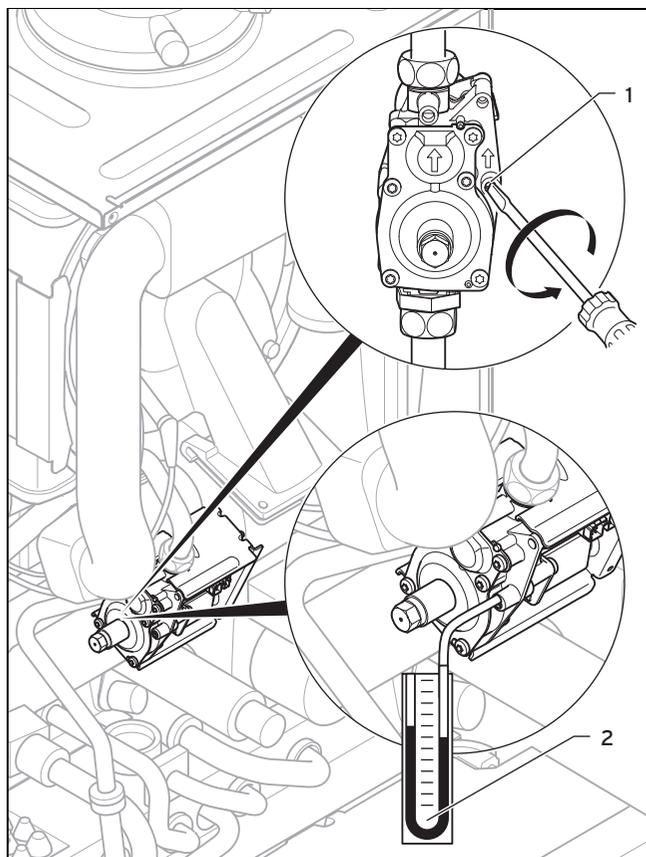
2. Lösen Sie die Messnippelschraube (1) (untere Schraube) an der Gasarmatur mit Hilfe eines Schraubendrehers.
