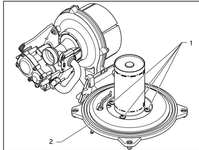
2. Lösen Sie die vier Schrauben **(1)** am Brenner.
