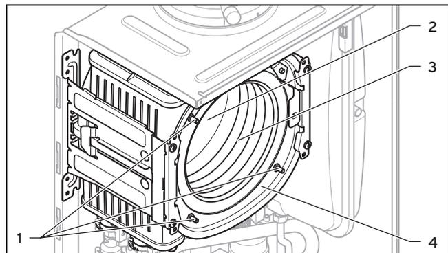
2. Lösen Sie auf keinen Fall die vier Muttern an den Stehbolzen (1) und ziehen Sie sie auf keinen Fall nach.
