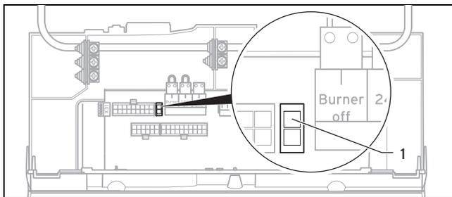
3. Ziehen Sie den Kodierwiderstand (1) (Stecker X24) auf der alten Leiterplatte ab und stecken Sie den Stecker auf die neue Leiterplatte auf.
