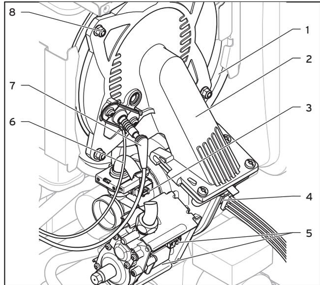
7. Ziehen Sie den Stecker der Zündleitung (7) und der Erdleitung (6) von der Zündelektrode ab.
