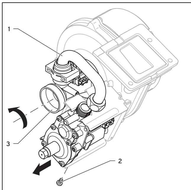
7. Nehmen Sie die gesamte Einheit aus Gebläse, Venturi und Gasarmatur aus dem Produkt.
