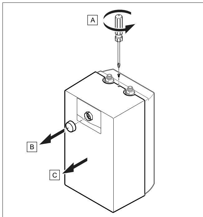
1. Lösen Sie (A) die Schraube zwischen den Hydraulikan schlüssen.
