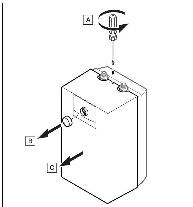
1. Otpustite (A) zavrtanj između hidrauličnih priključaka.
