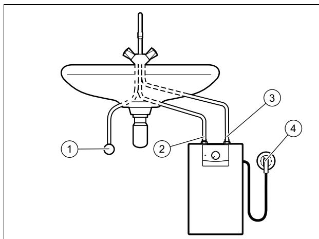
1 Koldtvandstilslutning      3 Koldtvandstilslutning
