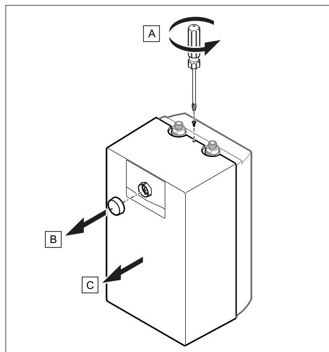
1. Lossa **(A)** skruven mellan de hydrauliska anslutningarna.
