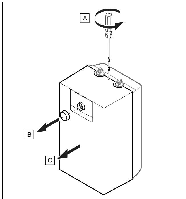
1. Draai (**A**) de schroef tussen de hydraulische aansluitingen los.
