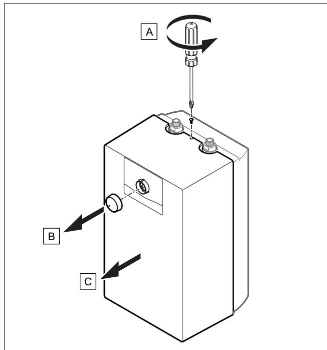
1. Løsne (A) skruen mellom hydraulikkoblingene.
