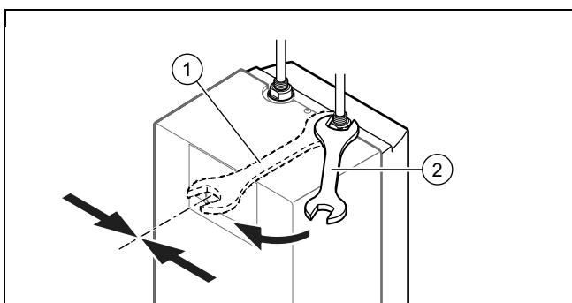
2. Schließen Sie das Produkt an die Niederdruckarmatur an.
