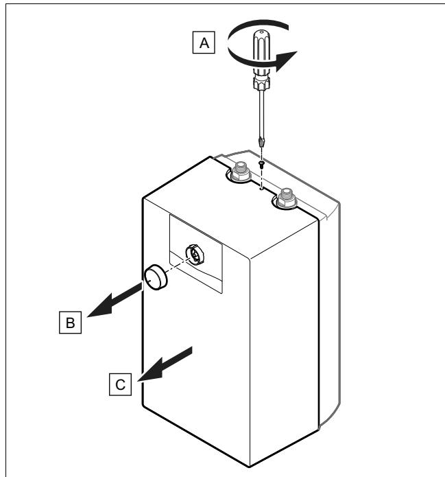
1. Popustite (A) vijak između hidrauličkih priključaka.
