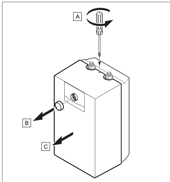
1. Løsn (A) skruen mellem hydrauliktilslutningerne.
