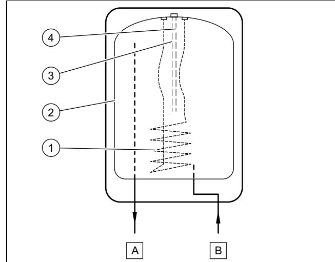
1 Résistance électrique      4 Capteur de température
