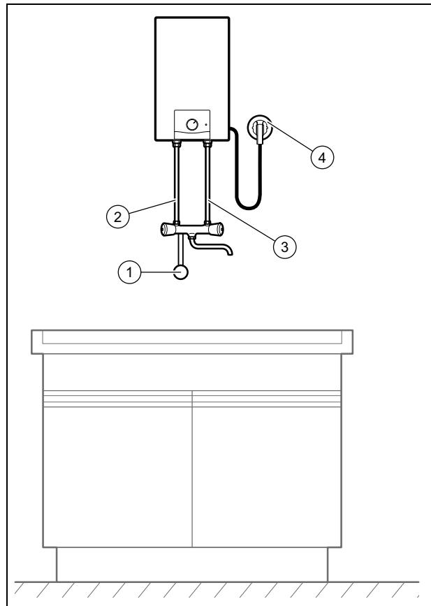
1 Koldtvandstilslutning      3 Koldtvandstilslutning
