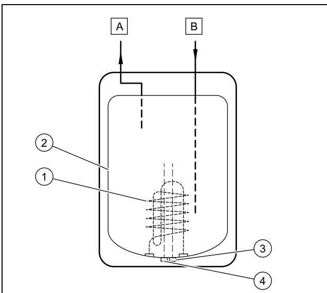
1 Résistance électrique      4 Capteur de température
