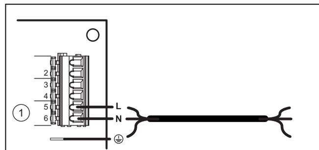
1. Wenn das Netzanschlusskabel des Produkts beschädigt ist, dann muss es ausgetauscht werden.
