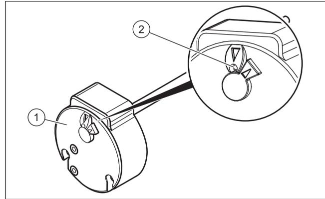
1. Prüfen Sie vor dem Zurücksetzen des Sicherheitstemperaturbegrenzers (1), ob Betrieb nicht von einem Niedertarifkontakt oder einer Zeitprogrammierung ausgeschaltet ist.
