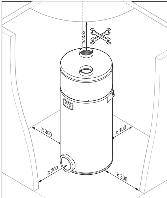
1. Beachten Sie die oben angegebenen Mindestabstände, um einen ausreichenden Luftstrom und die Wartungsarbeiten zu gewährleisten.
