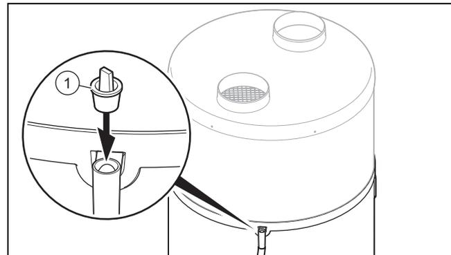
1. Wenn Sie einen Blower-Door-Test durchführen wollen, dann müssen Sie den Kondensat-Überlauf des Produkts verschließen.
