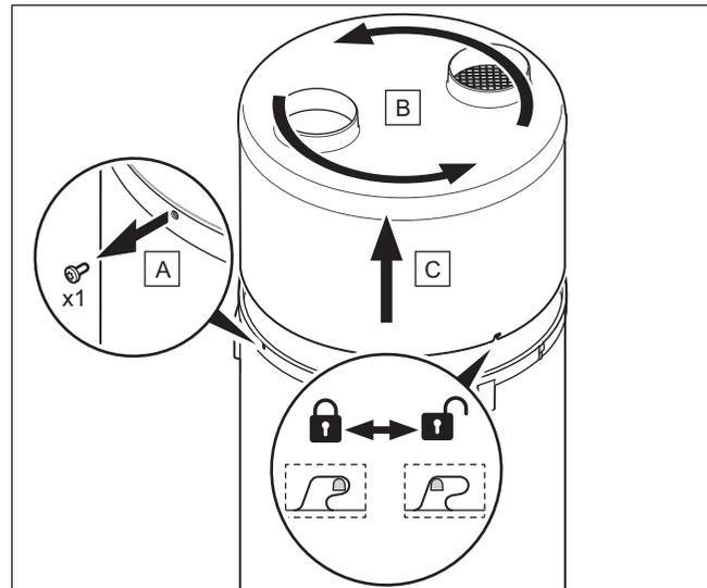
1. Drehen Sie die Schraube (A) am Ring des Produkts mit einem Torx-Schraubendreher um einige Millimeter heraus.
