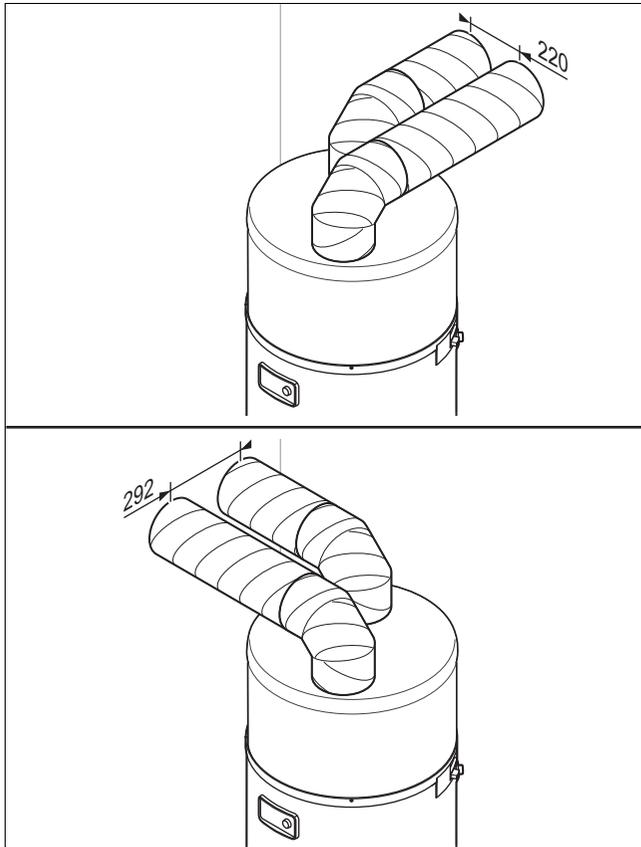
Diese Installationsart eignet sich insbesondere für Räume mit geringen Abmessungen (Vorratskammer, Abstellraum usw.).
