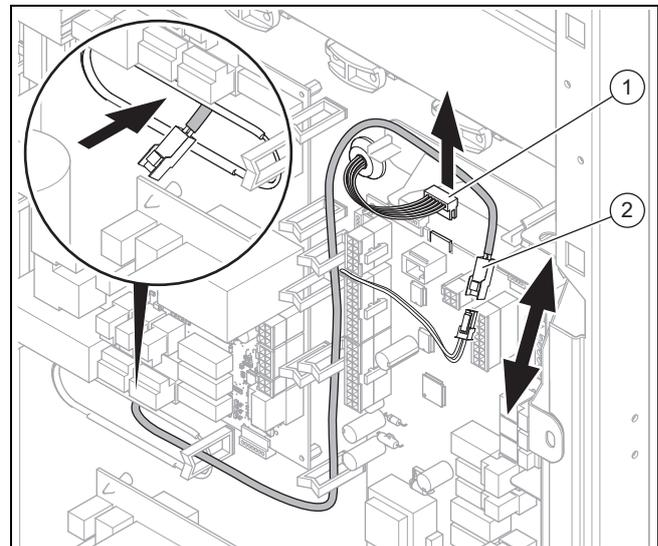
5. Ziehen Sie den Stecker des Bedienfelds (1) von der Reglerleiterplatte ab und trennen Sie die Steckverbindung des Speichertemperatursensors (2).
