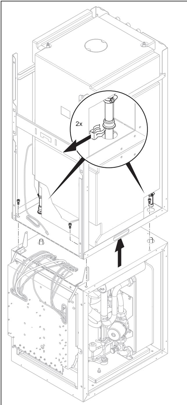
12. Ziehen Sie auf beiden Seiten die Klammern zur Verbindung von Heizungsvorlauf und -rücklauf mit dem Speicher ab.
