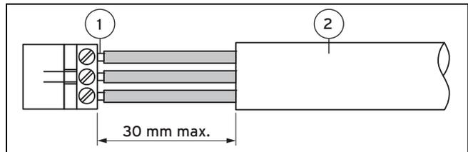
1 Anschlussdrähte 2 Isolierung
