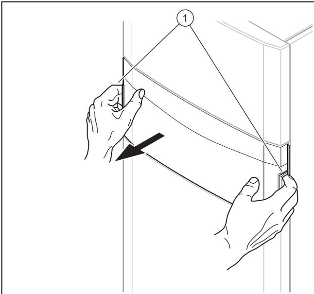
1. Demontieren die Frontklappe des Bedienfelds, indem Sie mit beiden Händen in die Griffmulden fassen und die Frontklappe nach vorn abziehen.
