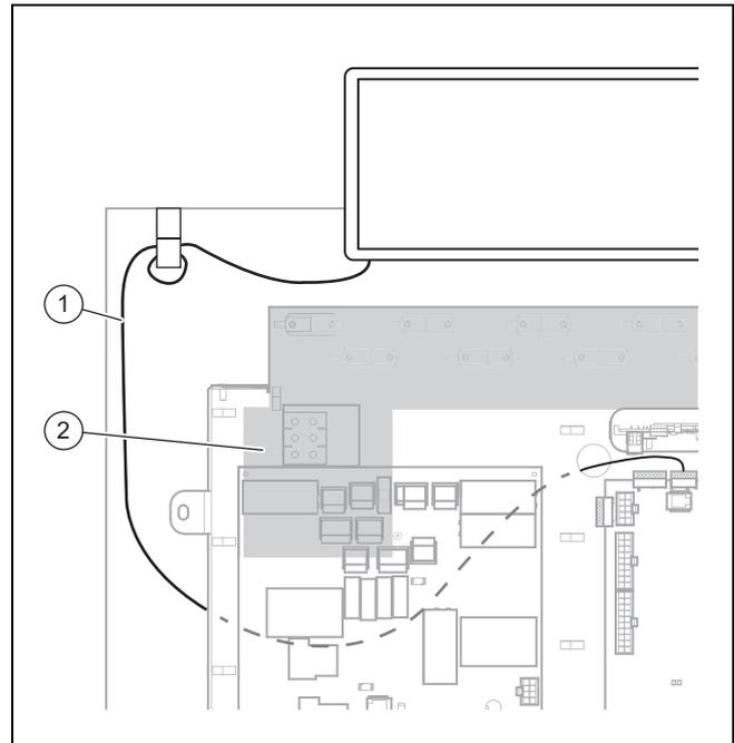
22. Verlegen Sie das Kabel des Bedienfelds (1) so, dass es nach dem Hochklappen des Schaltkastens außerhalb des markierten Bereichs (2) liegt.
