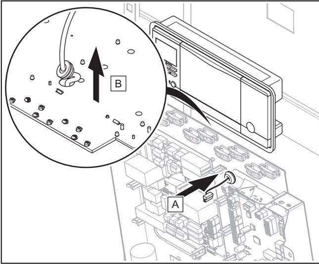
9. Lösen Sie die Gummitülle aus der Schaltkastenrückwand und ziehen Sie das Kabel des Bedienfelds inklusive Stecker nach hinten aus dem Schaltkasten.
