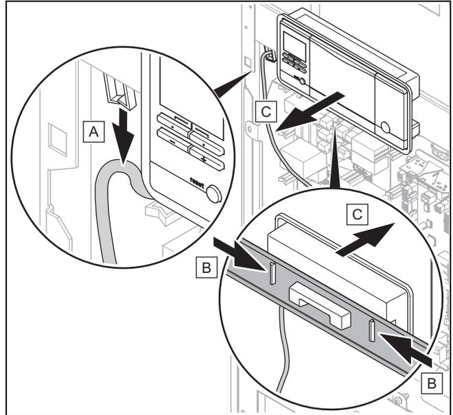
11. Lösen Sie das Kabel des Bedienfelds aus der Kabelführung und ziehen Sie es heraus. Lösen Sie das Bedienfeld aus dem Halter und nehmen Sie es ab.
