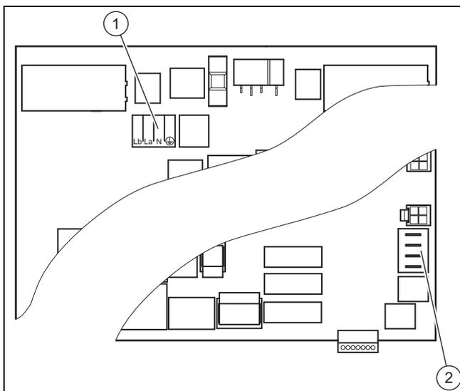
Für den Anschluss einer externen Brunnenpumpe steht ein Wechselkontaktanschluss X143 (1) mit der Belegung Lb, La, N, PE zur Verfügung.
