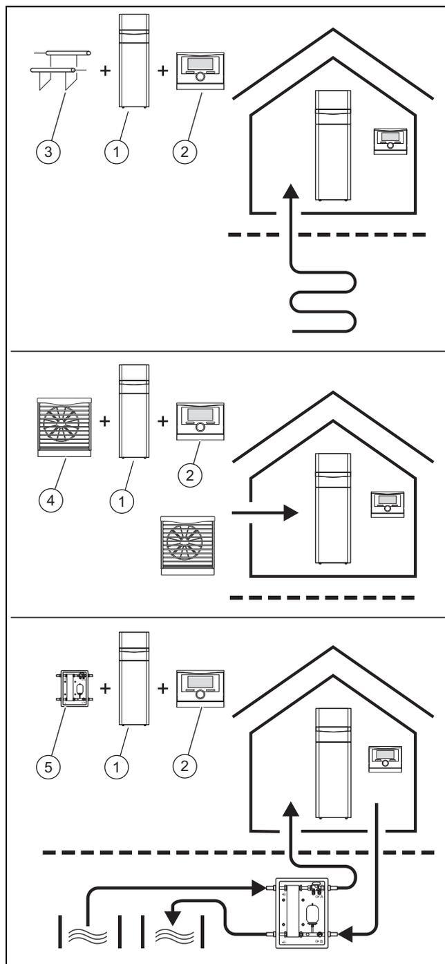
Das Wärmepumpensystem besteht aus folgenden Komponenten:
