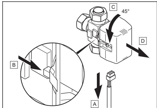
15. Ziehen Sie das Stromversorgungskabel am Motorkopf des Umschaltventils ab (A).
