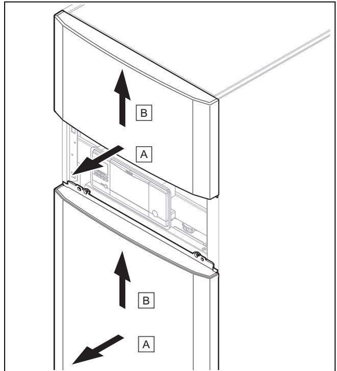
3. Ziehen Sie den oberen und den unteren Teil der Frontverkleidung jeweils etwas nach vorn ab und heben Sie ihn nach oben heraus.
