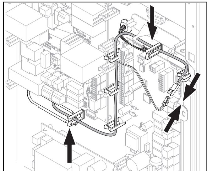
24. Achten Sie auf die korrekte Kabelführung im Schaltkasten und die richtige Reihenfolge der Kabelumspritzungen im Kammblech.
