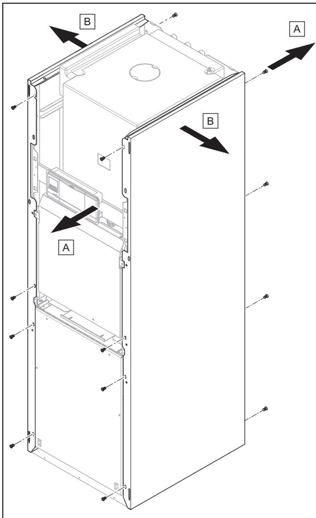
1. Drehen Sie 4 Schrauben vorn und 4 Schrauben hinten zur Demontage einer Seitenverkleidung heraus.
