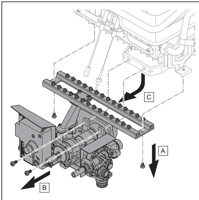
7. Ziehen Sie die Zündelektrode und die Überwachungselektrode, die an dem Schaltkasten angeschlossen sind, heraus.
