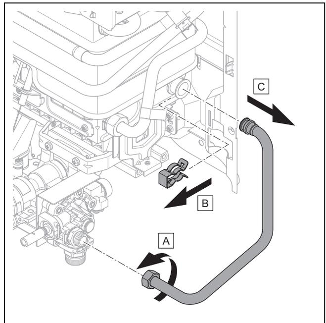
5. Schrauben Sie die Überwurfmutter am Wasservertil ab. Entfernen Sie den Clip am Kaltwasseranschluss des Brenners.
